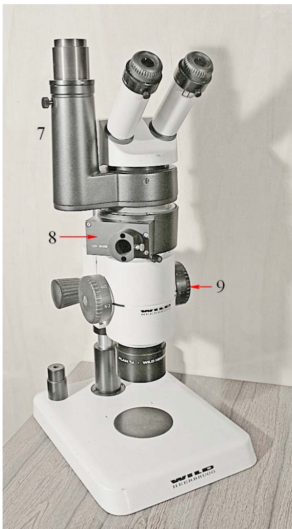
Fig. 41 (a sinistra) – Nel modello M8 della casa Wild, a sistema CMO con zoom (9), entrambi gli oculari sono regolabili. Si aggiunge un tubo per fotografia (7) ed un illuminatore episcopico coassiale (8).
