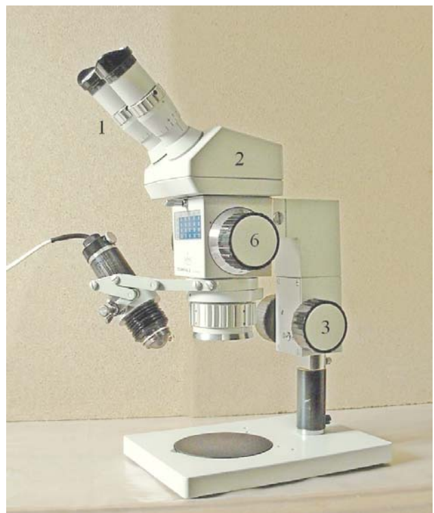
Fig. 41 (a sinistra) – Nel modello M8 della casa Wild, a sistema CMO con zoom (9), entrambi gli oculari sono regolabili. Si aggiunge un tubo per fotografia (7) ed un illuminatore episcopico coassiale (8).
