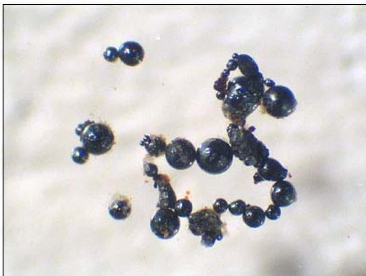
Figura 3 - Micrometeoriti ferrose. Sono collegate a formare collanine per via del magnetismo residuo dovuto all'uso del magnete per la loro ricerca. Diametro della più grande = 0,25 mm.
