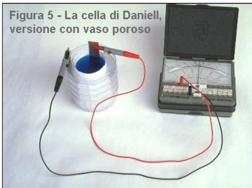
l'elettrodo di rame richiama gli ioni positivi dell'elettrolita. Quindi, gli ioni  $\text{Cu}^{++}$  si dirigono verso l'elettrodo di rame, dove prelevano due elettroni, si neutralizzano e si depositano in forma metallica, quelli  $\text{Zn}^{++}$  si muovono verso il vaso poroso. Per ogni atomo di rame che si deposita, un atomo di zinco va in soluzione cedendo due cariche al proprio elettrodo.
