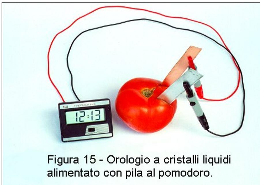
Figura 15 - Orologio a cristalli liquidi alimentato con pila al pomodoro.
