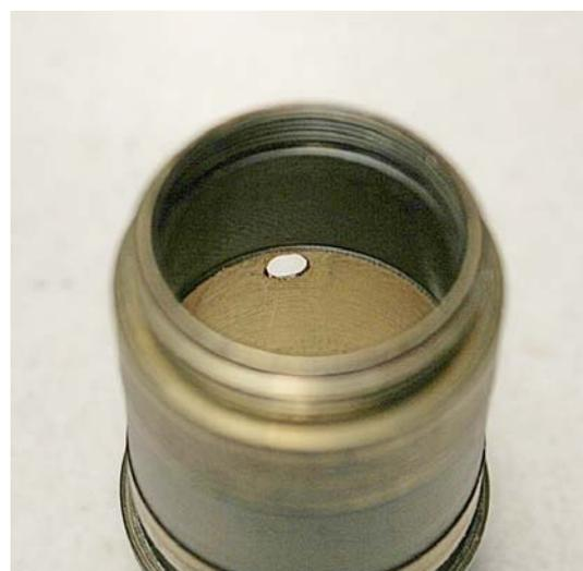
Fig. 1771 (sinistra) – Visto da sopra, dopo aver smontato il diaframma superiore Ds, il barilotto generale mostra un anello a vite (14) che serve a serrare il pacco lenti. È questo anello che risultava allentato nell'obbiettivo, prima dell'intervento qui descritto (era questa la "quarta sorpresina").
