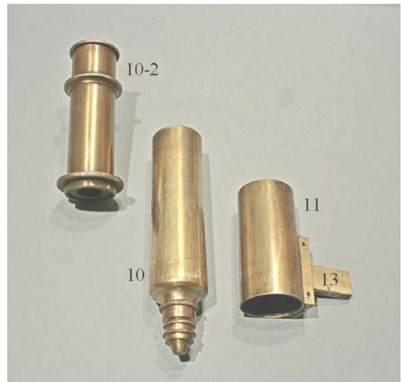
Fig. 1809 – Il tubo 10 è formato da due parti che s'avvitano l'una sull'altra. Inferiormente, la parte superiore (10-2) porta verso il basso un diaframma che serve ad eliminare i raggi troppo obliqui ("light baffle").
