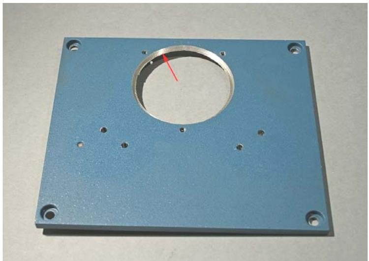
Fig. 1784 – Il tubo Nikon, da sotto. Il suo disco di fissaggio presenta le tre tacche già viste ed alcuni incavi che ne riducono lo spessore utile. Per fissare la piastra della figura precedente al disco qui visibile occorre che le viti evitino gli incavi in modo da sfruttare l'intero spessore del disco stesso (4 mm). Pertanto sono stati praticati altri due fori (diametro 4 mm) nell'anello 2 della fig. 1781, come si vede nella figura qui sotto (freccie rosse).
