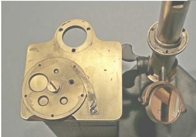
Fig. 1811 (a sinistra) – Molto semplice. Il disco comporta cinque fori ad orlo svasato (per evitare riflessi sui bordi del foro) e cinque forellini sul bordo. In questi ultimi s'inserisce la punta di una lamina arcuata, fissata da una vite ed una spina. Sono così stabilite le posizioni di lavoro del disco.
