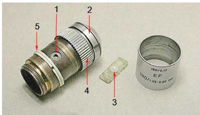
Poiché l’obbiettivo è a montatura telescopica, il chiodino 3, o analoga vite, serve ad impedire che il barilotto generale possa ruotare su sé stesso, visto che tale chiodino s’innesta in una scanalatura ricavata dal barilotto generale stesso (10 nelle figg. 1767/71).
