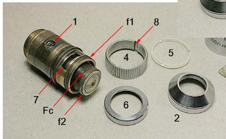
Fig. 1765 (a sinistra) – L’anello 4 porta internamente due scanalature longitudinali (8), destinate ad accogliere la testa della vite che deve comandare il diaframma interno. Tale vite (se ci fosse) ruoterebbe nella scanalatura 7.
