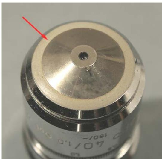
Dalla parte superiore, l'obbiettivo consente un facile smontaggio di un anello a vite che tiene in sede la molla che contrasta il movimento a pompa (figura seguente). Ma questo non aiuta ad accedere ai fori di centratura.
