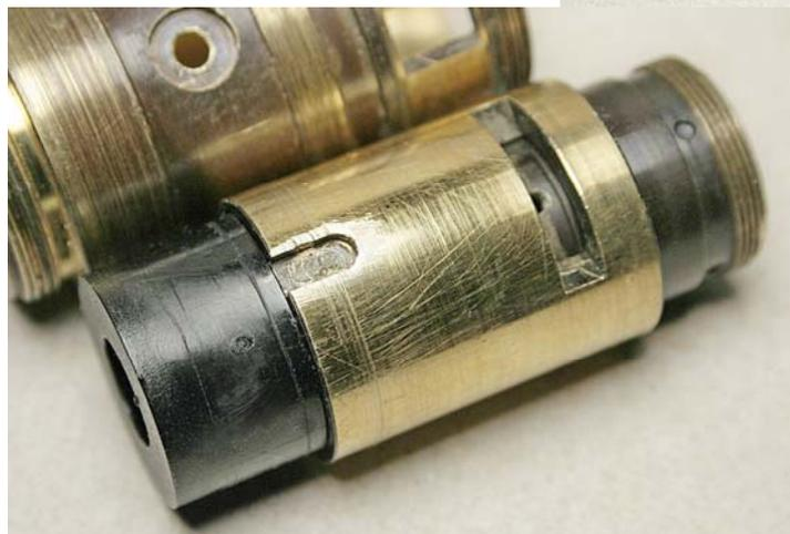
Fig. 1769 (sinistra) – Guardando più da vicino, si vedono i segni dalla raschiatura della bava sui bordi della scanalatura 10.
