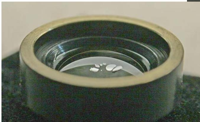
Fig. 1755 (a sinistra) – Il menisco inferiore, in luce radente, mostra delle macchie chiare, dovute a riflessione totale all'interno di piccole zone di scollatura. Sono queste macchie che, in trasparenza, apparivano bordate di blu nella foto. 1751 (destra).
