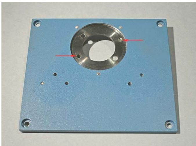
Fig. 1785 (sopra) – La piastra originale del Polyvar, col foro allargato e l'anello 2 modificato.
