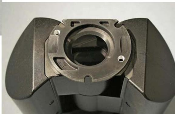
Fig. 1787 – Il nuovo tubo in posizione. Si vedono le due teste cilindriche delle nuove viti che lo reggono da dentro.
