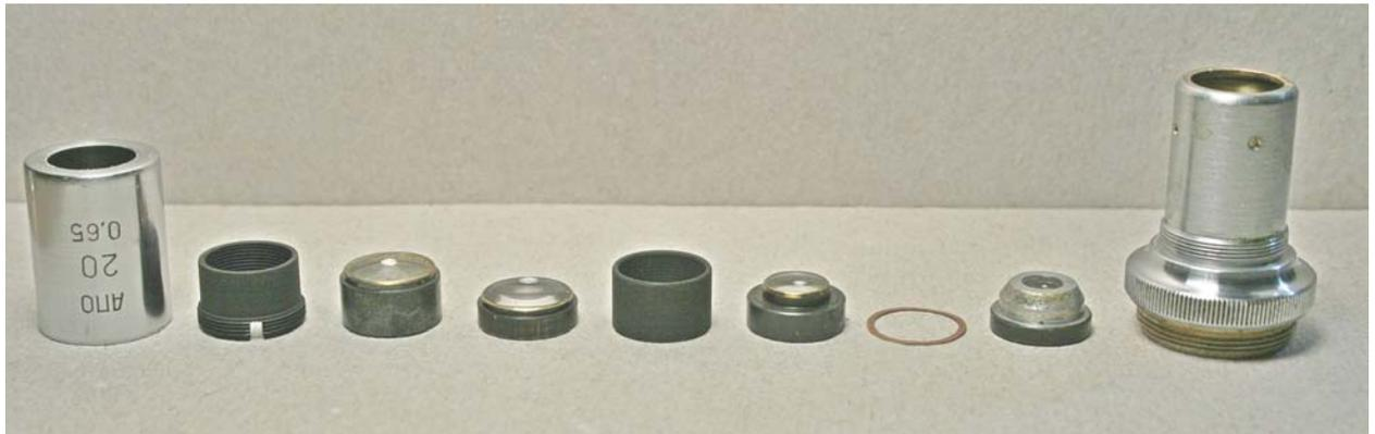
Fig. 1753 – Ecco un sistema non del tutto classico, a duplexfront: una frontale, un menisco convergente (che però non è una lente semplice, ma un doppietto) un menisco semplice, un tripletto in alto. Un tubetto distanziale si trova fra i due menischi; un anellino per la correzione della sferica fra frontale e menisco inferiore. Nulla di strano. Si noti che il tubetto distanziale non è simmetrico: il diametro interno è maggiore dal lato superiore.
