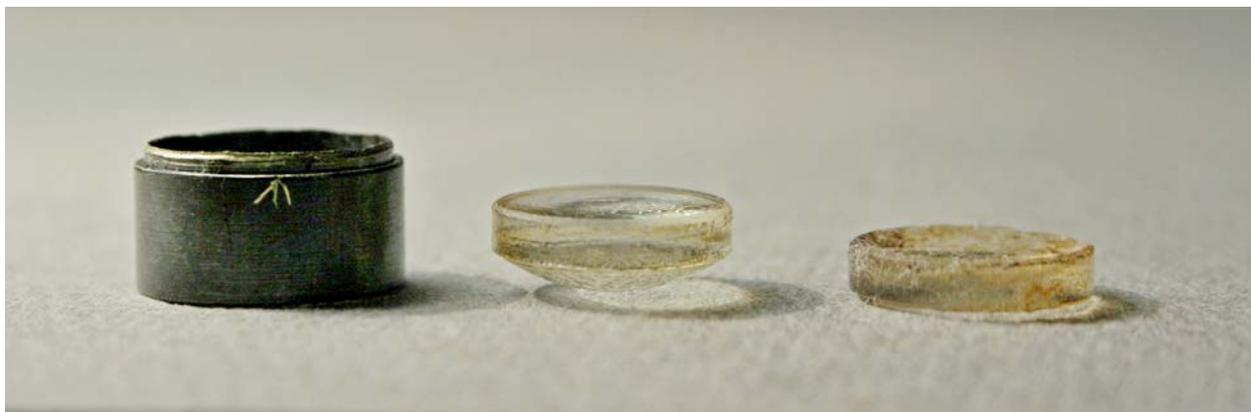
Fig. 1757 – Scaldando e spingendo ancora, il tripletto è estratto e comincia a staccarsi l'elemento divergente superiore (tutti i pezzi, anche nelle due figure precedenti, sono disposti capovolti rispetto alla posizione di lavoro normale). La "scientifica" scopre residui di Balsamo un po' carbonizzato sui bordi delle lenti.
