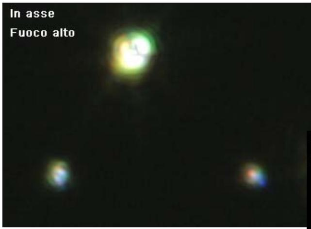
Fig. 1775 a/b/c – Nonostante che i fori scelti nello star test non siano abbastanza piccoli (l'obiettivo è forte, ed è difficile trovare dei fori di dimensioni adeguate), la presenza degli anelli di diffrazione è evidente nel miglior fuoco.
