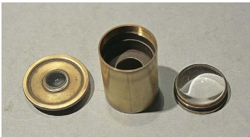
Fig. 1815/16/17 – Il diametro esterno è standard: 23,2 mm. Lunghezza  $l = 32,8$  mm. Il diametro del barilotto superiore è  $\varnothing_p = 28,4$  mm. L’altezza di pupilla è:  $A_p = 5$  mm. L’altezza dell’immagine intermedia è  $A_i = 9$  mm. Indice di campo:  $s' = 18$  mm, e questo consente un campo angolare di  $2\alpha = 40^\circ$ , quasi grandangolare.
