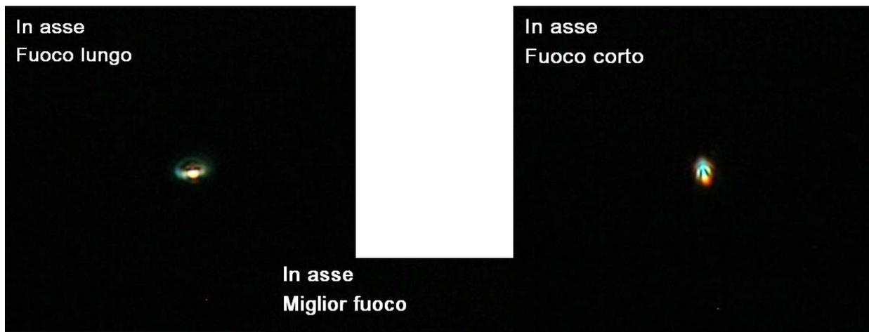
Fig. 1760 – Le centriche sopra e sotto il miglior fuoco sono allungate in direzioni reciprocamente ortogonali: residuo di astigmatismo in asse. Errore di montaggio delle lenti? Cattivo allineamento dell'elemento centrale del tripletto? Introvabile qualcuno disposto a ricominciare la sequenza descritta sopra. Revisione del processo negata.
