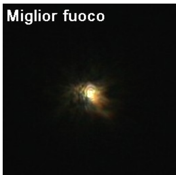
Fig. 1737/38 – Il contrasto è pessimo (reticolo a passo 20+20 \mu , oculare acromatico 10 \times /20). La centrica, al centro del campo, non lascia molte speranze (oculare acromatico 10 \times /15; ingrandimento successivo 6:1).
