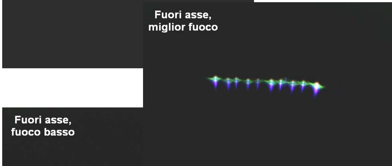
Figg. 1715/17 – Fuori asse, ai margini di un campo di 18 mm, si vedono tonnellate di astigmatismo. L'obbiettivo è acromatico, e per giunta planare: tutto prevedibile.
