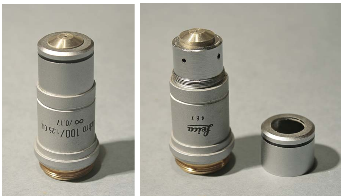
Fig. 1693 – La struttura meccanica è semplice: mancando il meccanismo telescopico, si vede solo una corta camicia avvitata sulla montatura generale. Sotto la camicia, i quattro fori di centratura; poiché i fori sono ancora otturati da una goccia di mastice nero, si dovrebbe dedurre che non vi siano stati interventi dopo la vendita.
