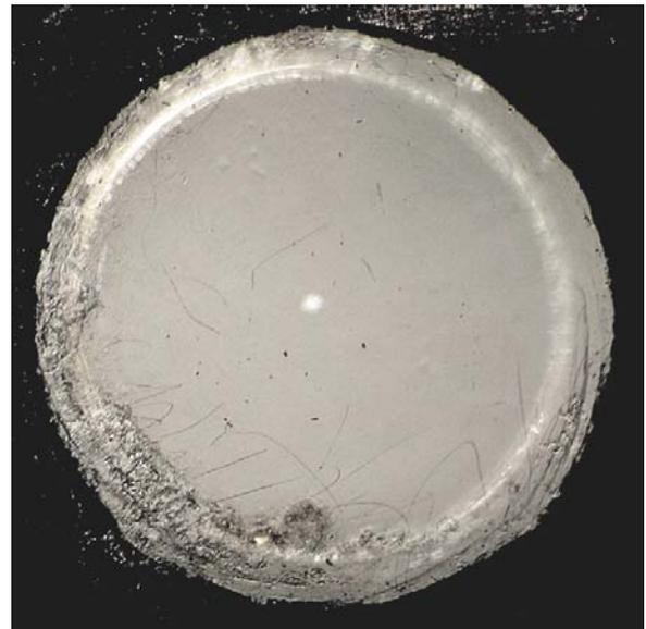
Fig. 1671 (a sinistra) – Illuminata per riflessione, la lente emergente appare coperta da una fitta ragnatela. È il fenomeno noto come “fungus”, vale a dire una proliferazione di miceti inferiori (in parole povere: muffe), che si possono sviluppare su qualunque superficie in atmosfera umida.
