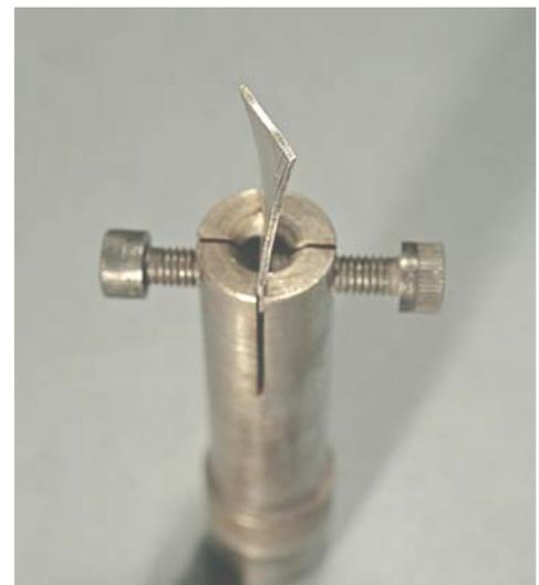
Fig. 1686 – Una tale resistenza a muoversi trova spiegazione nell'ossidazione delle parti, come appare visibile anche in altre parti nella figura che segue (Cr).
