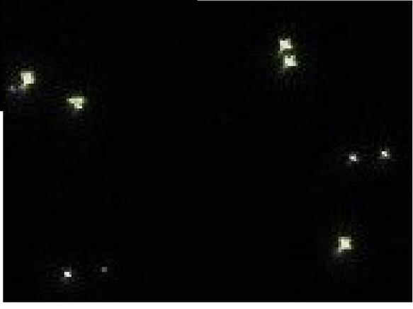
Fig. 1651 – Obiettivo 10. Anche qui, a tutto campo non si vedono residui di aberrazioni. Ingrandendo di tre volte un particolare, preso dal margine superiore del campo (figura sopra), si vedono solo lievi segni di astigmatismo: le centriche assumono la caratteristica forma “a rondinella”, cioè una crocetta dovuta a sovrapposizione delle focaline astigmatiche tangenziale e radiale. A destra, un particolare ulteriormente ingrandito.
