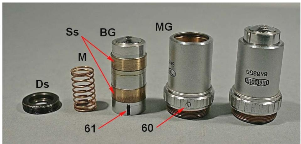
Il barilotto generale mostra due superfici cilindriche in rilievo (**Ss**) che scorrono all’interno della montatura generale **MG**.
