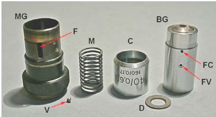
Fig. 1673 (a sinistra) – Prima fase dello smontaggio. Si noti che il movimento a pompa del barilotto generale è limitato verso il basso dall'orlo rientrante della camicia C; tale orlo determina quindi la lunghezza di parfocalità dell'obiettivo e, se si allenta la camicia, può aumentare quella lunghezza.
