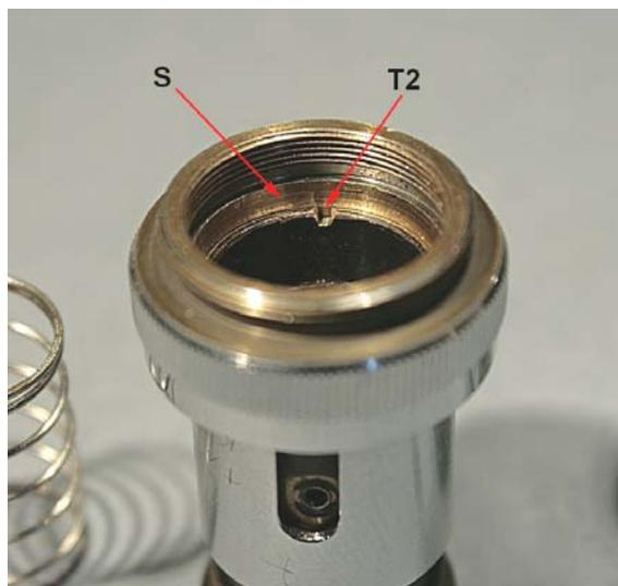
Fig. 1683 (a sinistra) – Dopo aver tolto il diaframma superiore  $D_s$  e la molla M (vedi la fig. 1685) appare l'estremità superiore del barilotto generale (BG), il quale però si trova bloccato in posizione “tutto dentro”.
