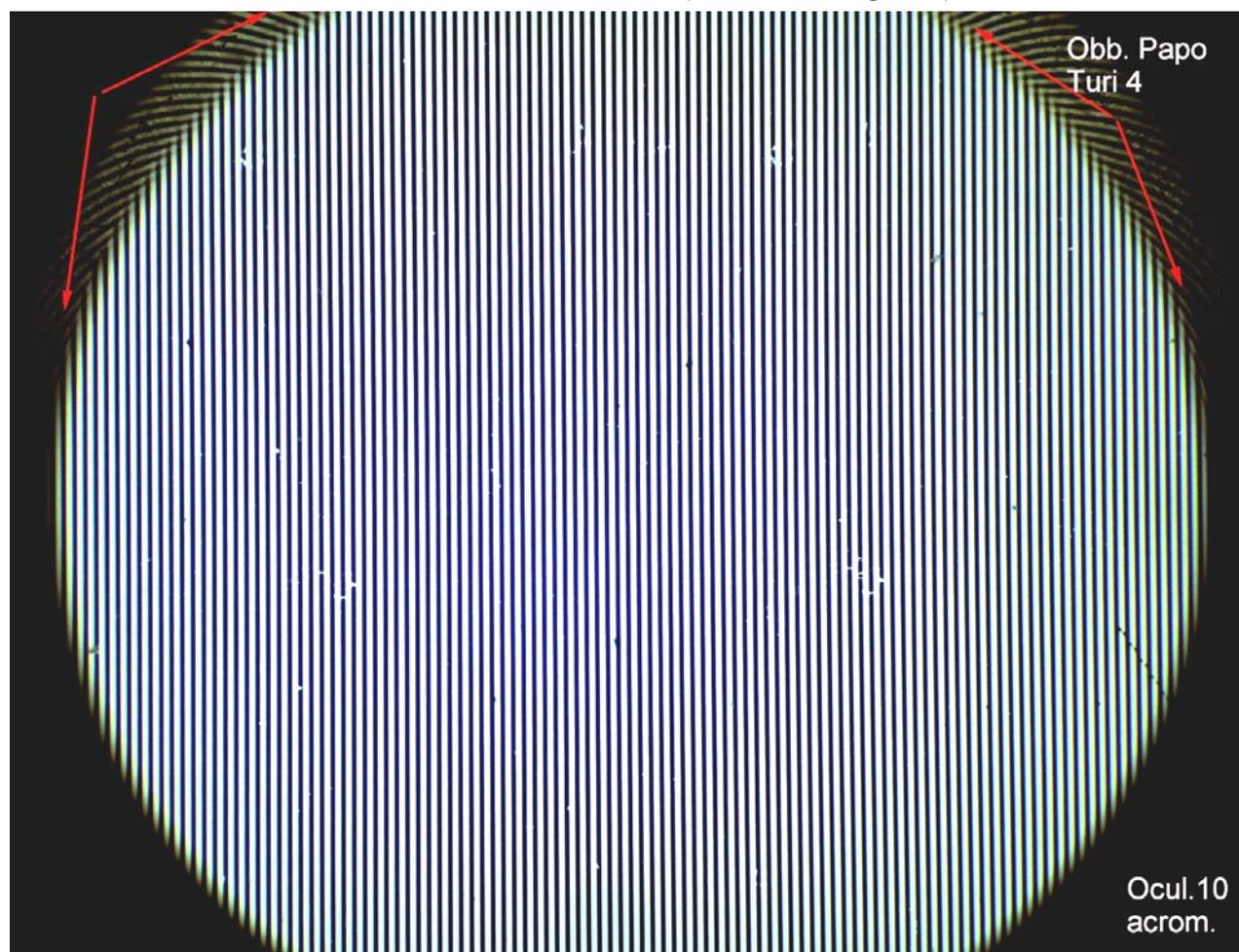
Fig. 1646 – Obiettivo 4 / 0,16. Usando un oculare acromatico 10 ×, con un indice di campo  $s' = 18$  mm, si ha un'immagine veramente eccezionale per contrasto e planeità.
