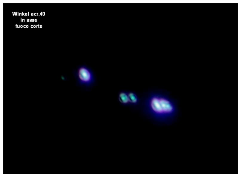
Figg. 1679/81 – Ai margini di un campo di 18 mm, sono evidenti i segni dell'astigmatismo. Poiché il centro del campo si trova in basso, fuori figura, è ovvio che le focaline non si trovano in direzione radiale: l'astigmatismo non è simmetrico, ed infatti l'abbiamo trovato anche al centro del campo.
