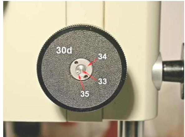
Fig. 1525 (a destra) – Per smontare la manopola sinistra (30s) occorre svitarla rispetto all'albero 33 tenendo stretta l'altra (30d). Poiché sia la manopola 30s, sia l'anello a due fori 31, sono filettati internamente, alla fine si svitano entrambi.
