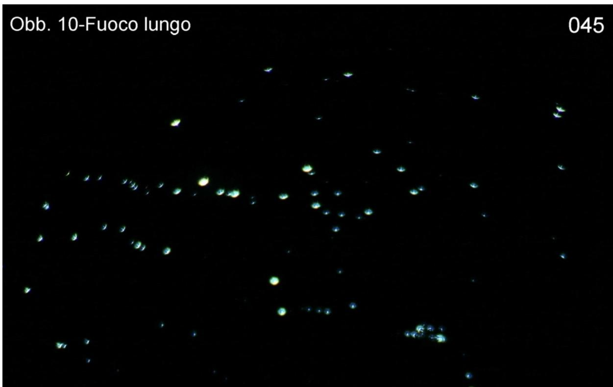
Fig. 1474 – Le centriche sono allungate tangenzialmente: segno quasi certo di astigmatismo (simmetrico, da progetto). Forse c’è anche un residuo di coma (simmetrica anch’essa). L’ingrandimento elettronico applicato a questa foto ed alle due seguenti è di circa 2 ×.
