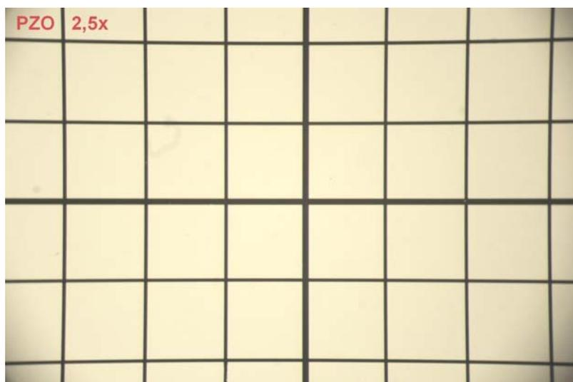
Fig. 1543 – Niente di nuovo. Poiché la distorsione si presenta in tutte le posizioni del cambiatore d'ingrandimento, ed in misura simile, in particolare nella posizione  $1,6\times$ , in cui i sistemi galileiani sono esclusi, la distorsione può dipendere solo dall'obbiettivo comune o, meno probabilmente, dall'oculare.
