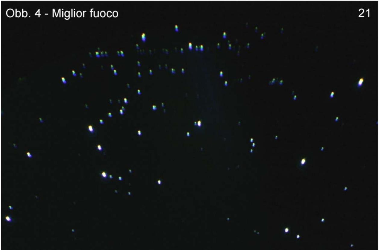
Fig. 1463 – È ancora evidente l'andamento allungato radialmente delle centriche. Può trattarsi di un residuo di astigmatismo o di coma simmetrica o di entrambi. Per distinguere fra i due casi, non c'è che abbassare il fuoco, come si vede e si commenta nella fig. 1465.
