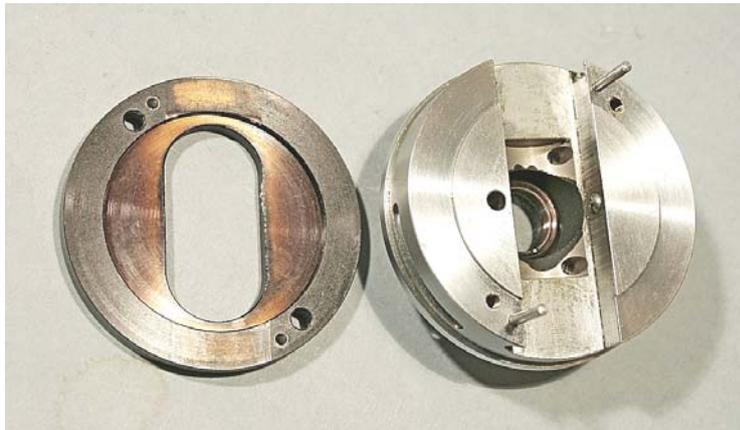
Fig. 1487 a/b (**sotto**) – La base 44, vista da sotto. Tre viti, accessibili da dentro, serrano il barilotto (45) della lente inferiore del Telan.
