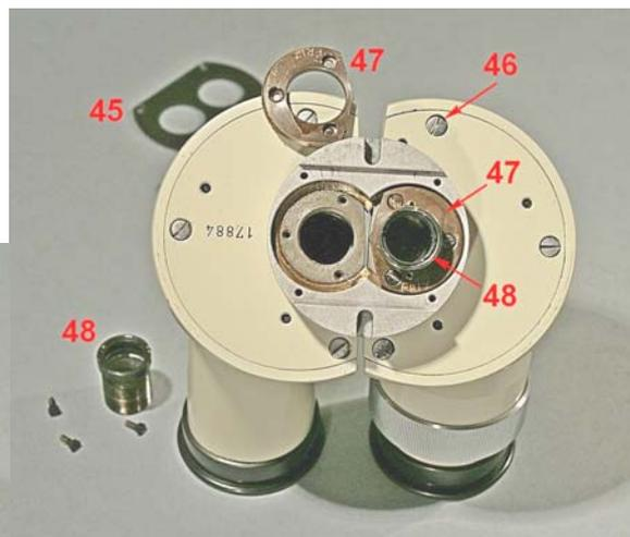
Fig. 1532 (a destra) – Tolle le 3 + 3 viti da sotto (alcune indicate con 46 nelle figure precedenti), ogni semi-tubo si separa in una piastra base (con il prisma) ed un coperchio, che a sua volta porta la boccia per l'oculare.
