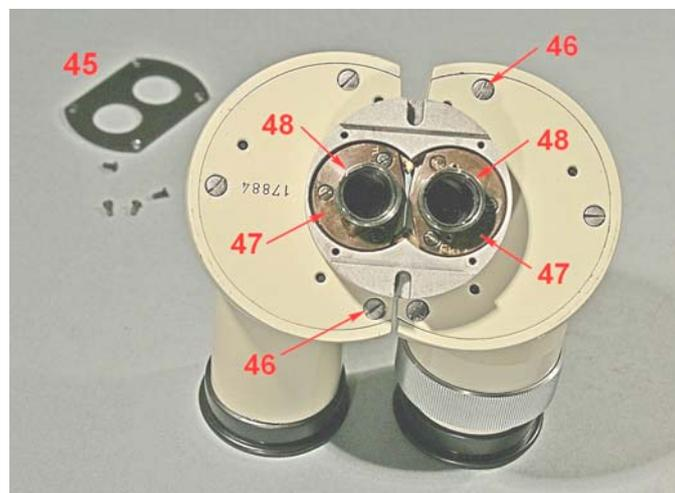
Fig. 1530/31 – I due anelli 47 si smontano togliendo le tre viti (vedi anche la figura precedente). I due barilotti 48 si svitano da sotto (circa 22 giri). A questo punto si sfilano verso l'alto i due semi-tubo, che non sono vincolati fra loro (in certi modelli, un sistema di denti rende simmetrici i loro movimenti).
