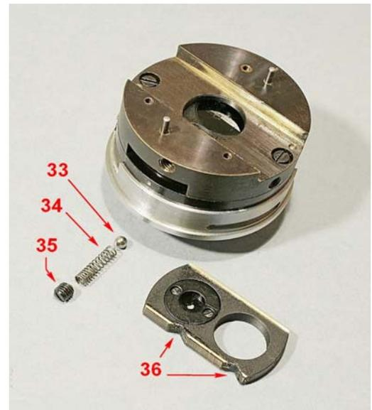
Fig. 1484 – Dopo tolte le due viti 20, si può staccare il blocco 25, contenente la guida del cursore della lente di Amici (14). Tale cursore mostra il barilotto della lente (21) e due intaccature (36); in queste, allo scopo di definire le posizioni di lavoro e di riposo del cursore, s'impegna la sferetta 33, spinta dalla molla 34 e dal grano 35. Tale gruppo (33+34+35) si avvita nel foro 32.
