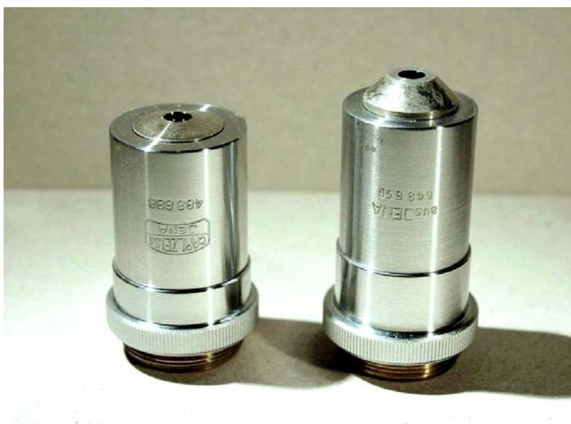
Fig. 1456 – La montatura generale è coperta parzialmente dalla camicia ed è formata da un solo pezzo (essa non è molleggiata, data la forte distanza di lavoro). La montatura contiene direttamente il pacco lenti (vedi oltre, alla fig. 1466, pag. 611).
