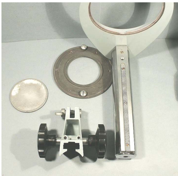
Fig. 1393 (a sinistra) – Visto di profilo, il braccio 2 col pignone mostra la sede della guida, che non è la solita coda di rondine a sezione trapezoidale.
