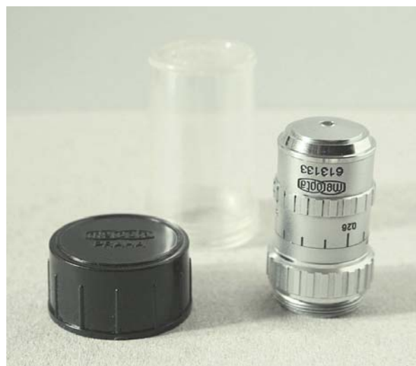
Fig. 1448 – È ben visibile, a metà altezza, l'anello godronato con la graduazione che indica lo spessore di copri oggetto per cui la sferica è meglio corretta. La graduazione va da d = 0,08 a d = 0,28 mm.
