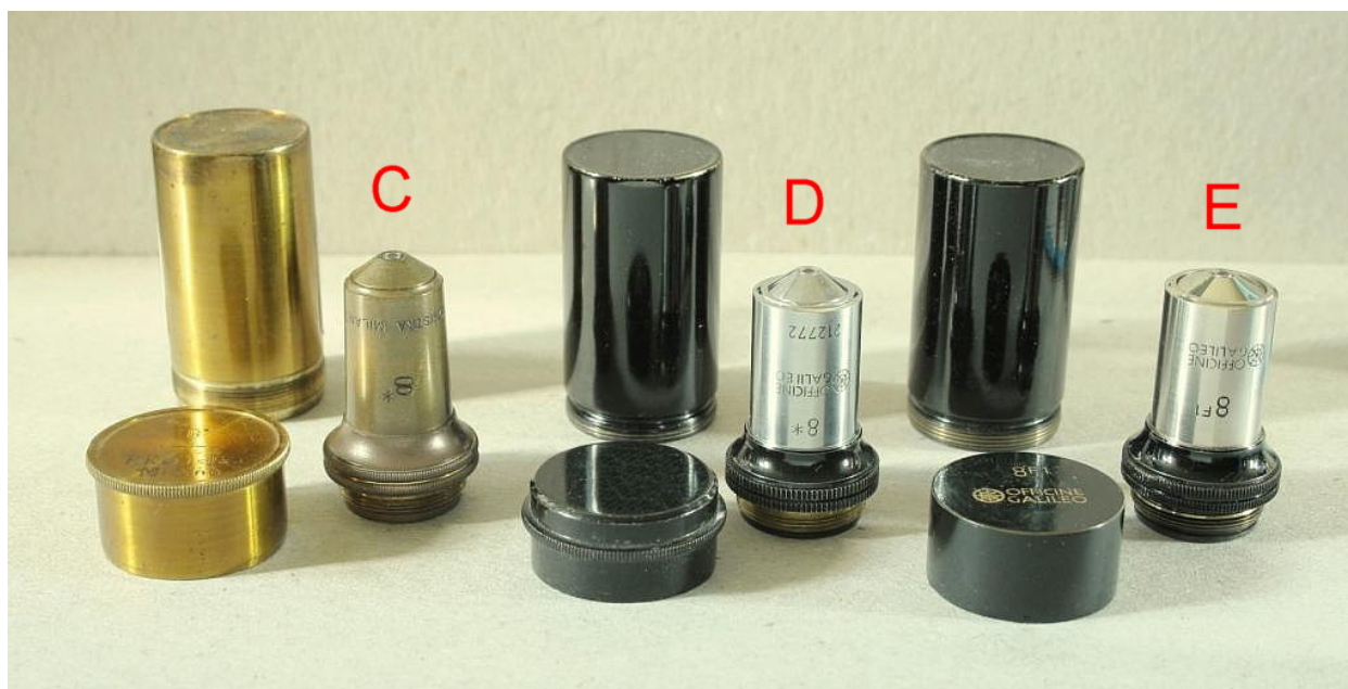
Fig. 1429 – Tre obbiettivi del numero 8, con struttura molto simile, specialmente i primi due. La loro apertura, (valore misurato) è, rispettivamente di 0,92, per i primi due, e 0,90 per il terzo. L'ingrandimento nominale è 64:1; quello misurato è, rispettivamente, 64:1 – 66:1 – 59:1. La distanza di lavoro (WD) è, rispettivamente, di 0,15 mm – 0,17 mm – 0,17 mm.
