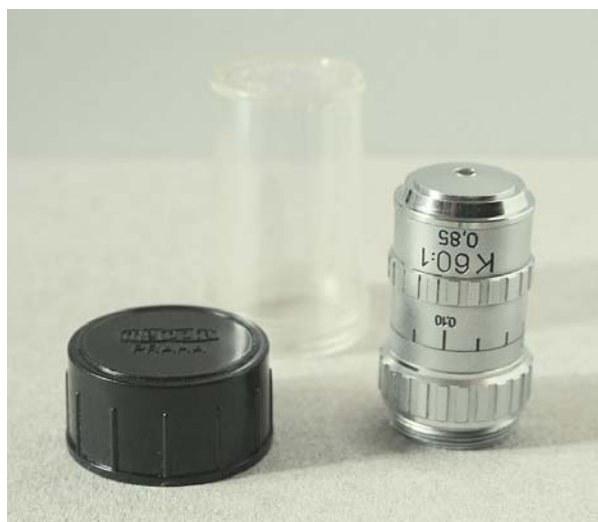
Fig. 1448 – È ben visibile, a metà altezza, l'anello godronato con la graduazione che indica lo spessore di copri oggetto per cui la sferica è meglio corretta. La graduazione va da d = 0,08 a d = 0,28 mm.
