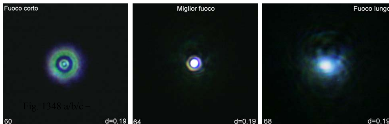
Fig. 1348 abc – Ancora con una lamella di spessore nominale ( d = 0,17 ), l'anello di correzione è stato impostato su un valore appena superiore, solo 0,02 mm in più ( d = 0,19 ). Anche qui appaiono le immagini “ad anelli” ( a ) e “sfumata” ( c ), ma in posizioni di fuoco invertite. Poiché l'immagine ad anelli compare col fuoco corto, la sferica è sottocorrecta (l'obiettivo sarebbe corretto solo impostando la correzione su d = 0,17 ).
