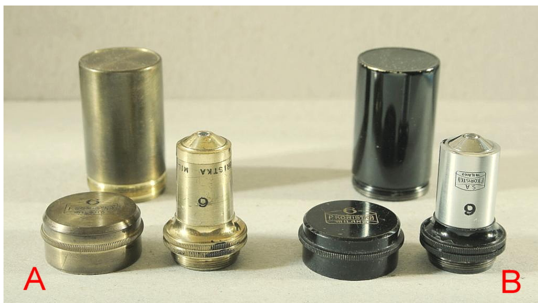
Fig. 1416 – Due obbiettivi di medio ingrandimento, due versioni della stessa ricetta, della prima metà del '900. I contenitori sono in ottone tornito, con vari tipi di finitura. La lunghezza ottica ( L_o ) è di 36 mm, con un tubo di lunghezza convenzionale di L_m = 160 mm.
