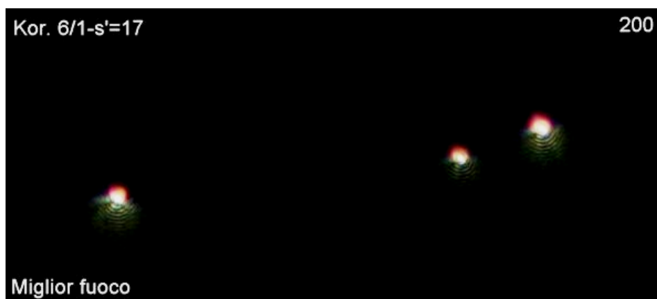
Fig. 1423 – Lo star test, osservato sui bordi del campo dell'obiettivo A della fig. 1416/17 con un oculare semicompensatore con indice di campo s' = 18 mm. Nelle condizioni di miglior fuoco, è ancora evidente un'asimmetria delle centriche.
