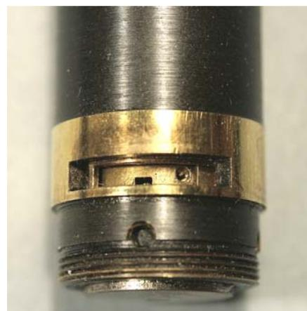
Fig. 1333 (a sinistra) – Dopo aver tolto la vite 13 dal foro 13b del barilotto generale 6, si può sfilare il barilotto stesso. Si notino in esso le due superfici di scorrimento (6c), ben rettificate.
