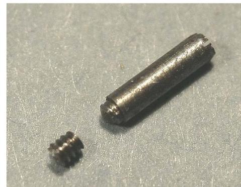
Fig. 1330 (a destra) – Una comune “semenzina” da calzolaio, a sezione quadrata, privata della testa, può essere afferrata a passata in una filiera da 1,0 mm, fino a produrre il manufatto visibile a destra.
