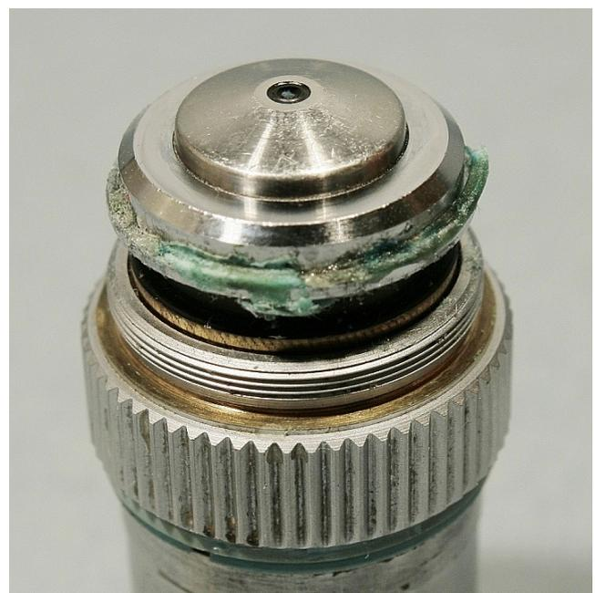
L'anello 1 si avvita sulla filettatura terminale (7) della montatura generale.
