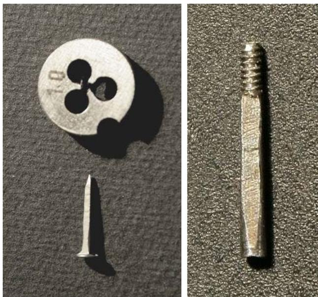
Fig. 1331 (a sinistra) – Osservando più da vicino la montatura generale (1b), ci si rende conto che nel foro 15 è imprigionata la punta del pernino originale (fig. 1329). Come estrarlo?
