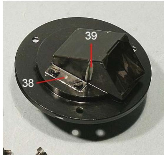
Per l'allineamento di questo prisma, si tenga conto comunque che un suo errore non dà gravi conseguenze, almeno a livello delle centrature, poiché le due riflessioni al suo interno si compensano a vicenda.
