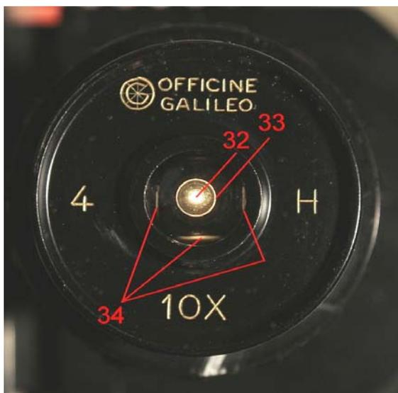
Fig. 1241 – L'interno del tubo, dopo tolto l'oculare. Oltre al fascio principale (32) ed al primo riflesso (33) si vede un ampio riflesso (35) che sembra dovuto al prisma centrale del tubo, sulla cui faccia d'ingresso è incollato un diaframma circolare ricavato da un sottile lamierino.
