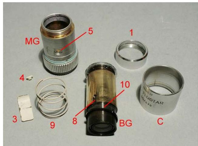
Fig. 1271 a/b – Appena l'anello 1 è stato svitato (con fatica, a mezzo di un foglio di para), è però apparso uno spettacolo sconsolante: uno strano cordone di materiale semitrasparente, proprio sotto l'orlo dell'anello, che impediva al barilotto generale di scendere del tutto.
