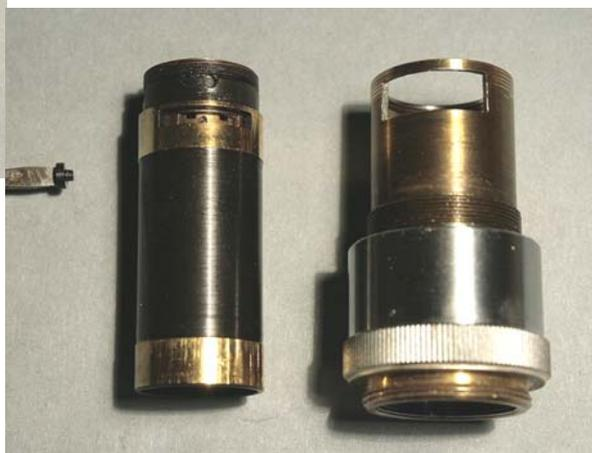
Fig. 1335 – Il barilotto generale, dall'alto, estratto dalla montatura generale.
