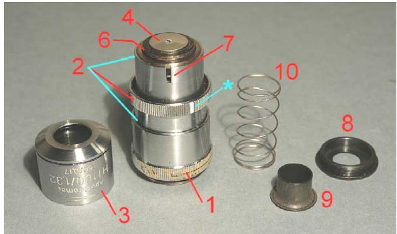
Ma ecco il rischio: ruotando la camicia 3, si obbliga a ruotare anche il barilotto generale (6 nelle figure seguenti) il quale trascina con sé la vite 13 (fig. 1327), ed essa spinge sull'orlo della fessura 12 (figura seguente), con elevata probabilità di spezzarsi.
