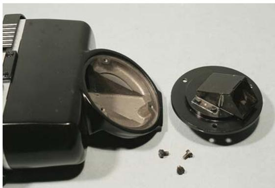
Fig. 1243 – Si vede bene il lamierino ripiegato a forma di U rovesciata, con due alette laterali fissate ognuna da due viti. È indicato (38) uno dei fori per la spinatura. In 39 si vede uno dei due cordoncini di adesivo che tengono il prisma fissato al lamierino. A destra, la faccia di emergenza del prisma.
