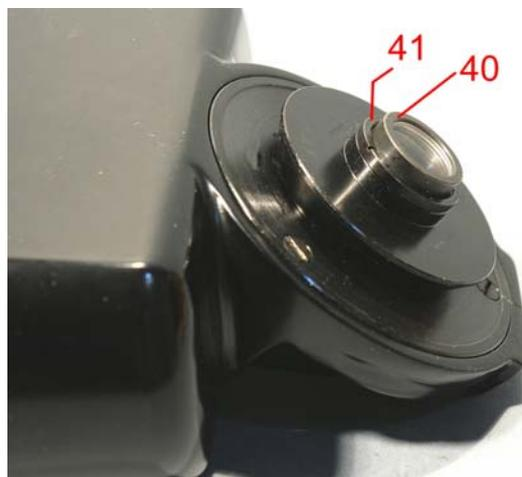
Fig. 1245 – Svitando il cilindro 40 (22 giri, senza muovere l’anello 41), si vede, in fondo alla sua sede, la lente convergente (C nello schema di sopra), mentre la lente divergente (D) è incastonata nell’estremità inferiore del tubo 40.
