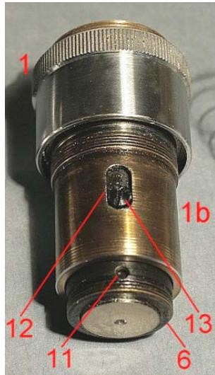
Fig. 1327 (a sinistra) – Più da vicino, si vede la fessura 12 in cui affiora la testa della vite 13.
