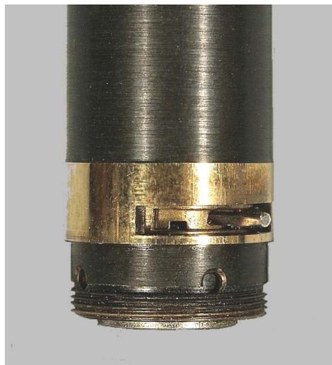
Fig. 1336 (a sinistra) – Prima di procedere al rimontaggio appena descritto, sarà bene verificare che l'impianto (il nuovo pernino) abbia attecchito ed il filetto si stringa nel foro. In questa fase, verificare anche che il pernino faccia ruotare liberamente il diaframma, senza interferire con le lamelle.
