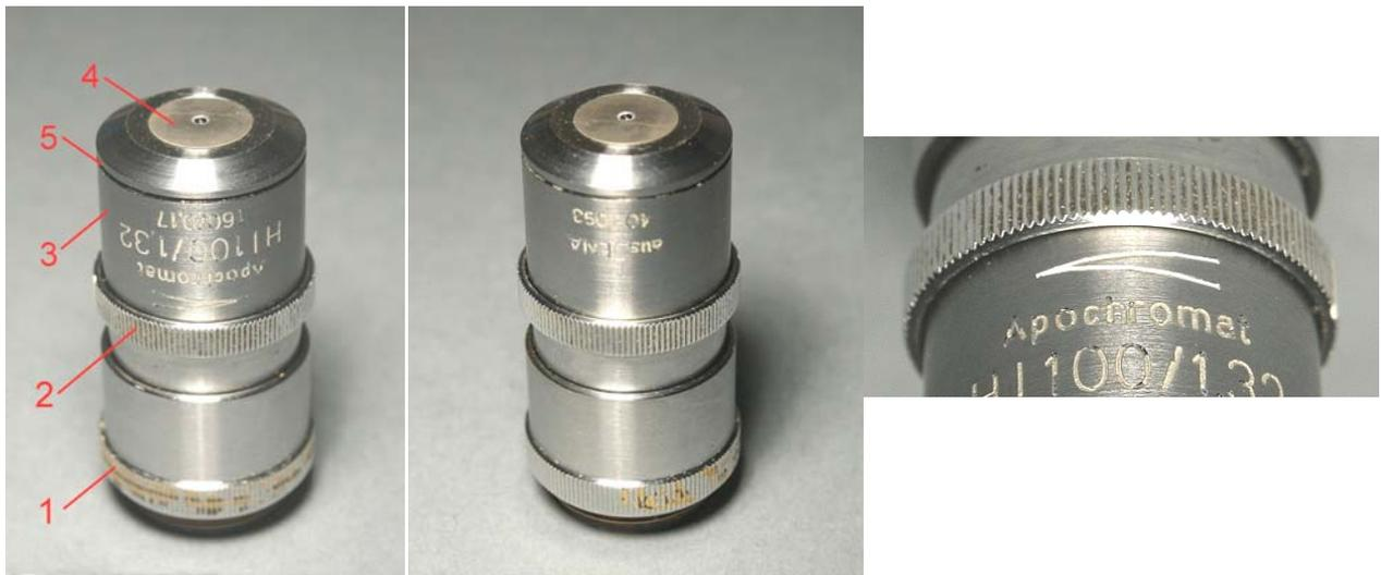
Fig. 1322/23/24 – L'anello godronato 1 serve ad avvitare o svitare l'obiettivo, ma inevitabilmente un utente frettoloso adopera a tal fine l'anello più a portata di mano, il 2, che comanda il diaframma. Ciò porta ad applicare al meccanismo interno una forza eccessiva, come capiremo meglio fra poco.
