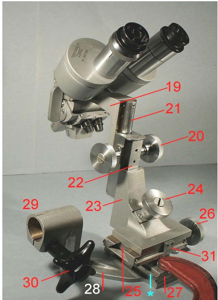
Fig. 1298 – Tutto il sistema delle guide è portato da un braccio ricurvo (28) munito di una boccola dal diametro interno di 24,5 mm (29), che si stringe colla manopola 30.
