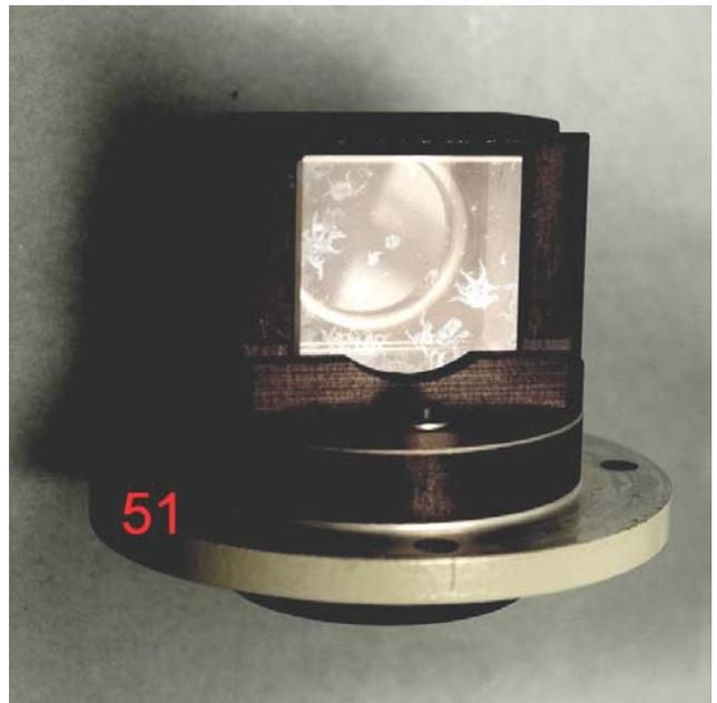
Per fortuna, l'attacco di quelle maledette Crittogame non è stato profondo ed un'energica pulizia con alcool è stata sufficiente. Rimane però una diffusa appannatura delle superfici, sia pure impercettibile.
