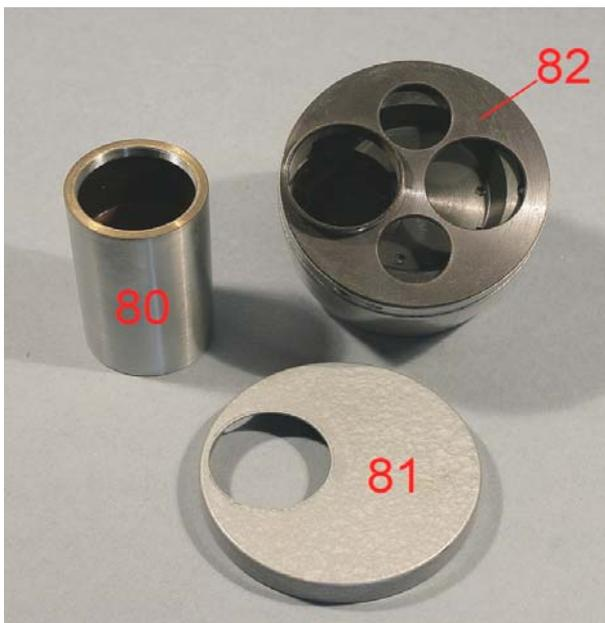
Fig. 1309 (a sinistra) – Dalla scatola dei prismi si può svitare il tubo porta-oculare (80) e con ciò si libera il coperchio 81, che non ha altri fissaggi.
