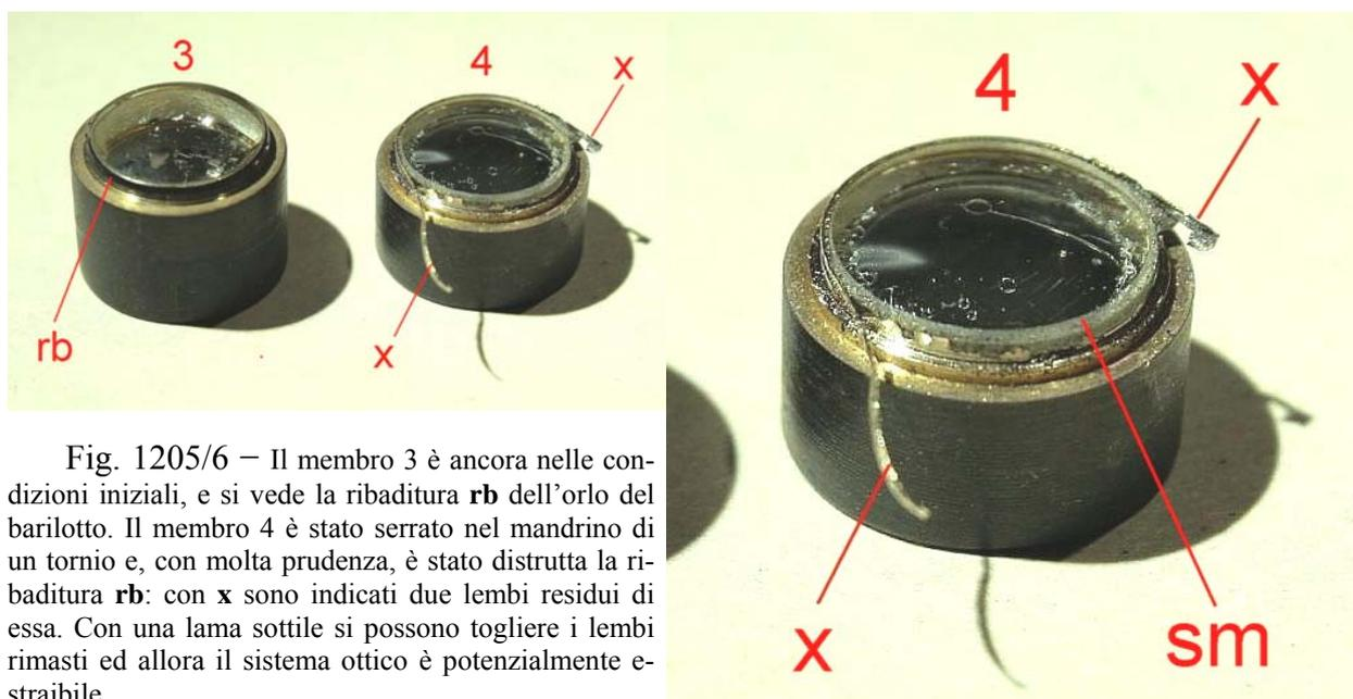
Fig. 1205/6 – Il membro 3 è ancora nelle condizioni iniziali, e si vede la ribaditura **rb** dell'orlo del barilotto. Il membro 4 è stato serrato nel mandrino di un tornio e, con molta prudenza, è stato distrutta la ribaditura **rb**: con **x** sono indicati due lembi residui di essa. Con una lama sottile si possono togliere i lembi rimasti ed allora il sistema ottico è potenzialmente estraibile.
