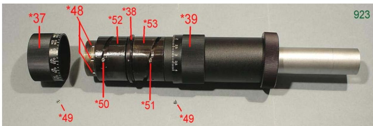
Fig. 1117 – Tolate le due viti a testa svasata \*49, si possono sfilare i due manicotti \*37 e \*39 ed appaiono allora due tubi (\*52 e \*53) sul fianco dei quali esiste una fessura elicoidale; in questa può scorrere la vite \*50 o \*51, la quale fa scorrere in direzione assiale uno dei due barilotti interni contenenti un sistema ottico.
