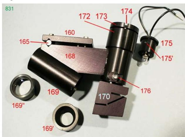
Fig. 1072 (sopra) – Un ulteriore stadio dello smontaggio, che mette in evidenza il porta-lampada (175) ed il grano che blocca lo zoccolo (175'). Sono smontate anche le due lenti del proiettore (due barilotti a vite, 169' e 169'').
