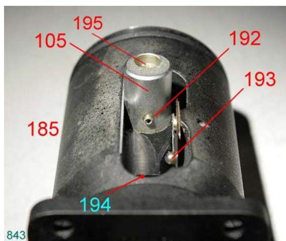
Eccoci finalmente alla parte bassa del braccio, che reca il “CAMBIATORE D'INGRANDIMENTO”. Si tratta di un disco revolver a quattro posizioni che porta dei sistemi intermedi capaci di introdurre nel sistema formatore d'immagine un “fattore di tubo” pari a  $1\times$  –  $1,25\times$  o  $1,5\times$ ; la quarta posizione porta la scritta “B”, e può servire ad inserire una lente di Amici-Bertrand (come è previsto dal progetto), oppure un sistema  $2\times$ .
