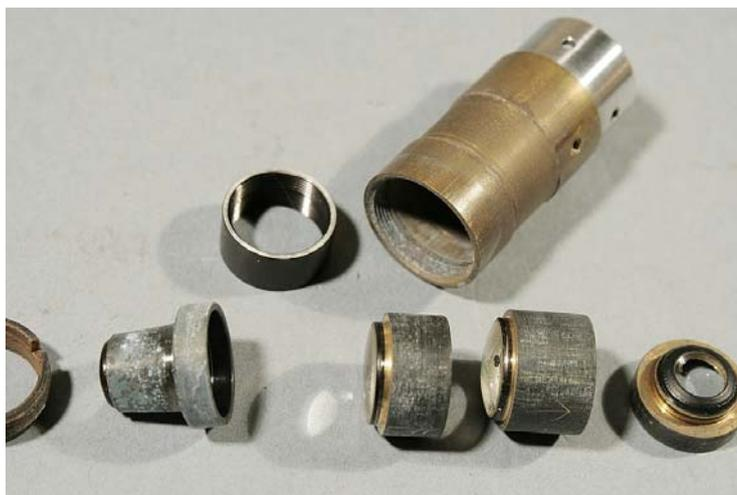
Fig. – 1201 – Un'incrostazione che procede così regolarmente dalla periferia verso il centro fa pensare ad un attacco chimico.
