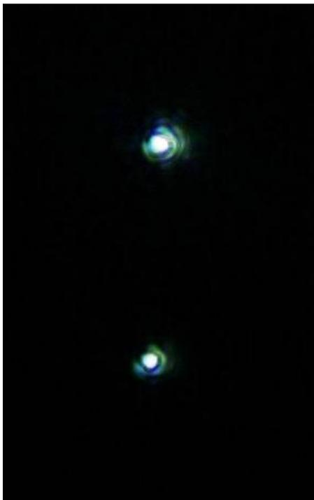
Fig. 1213 (a sinistra) – La centrica, alla fine della centratura, è regolare. Si vedono però delle piccole deviazioni da una simmetria perfettamente circolare: sono gli effetti della scheggiatura
