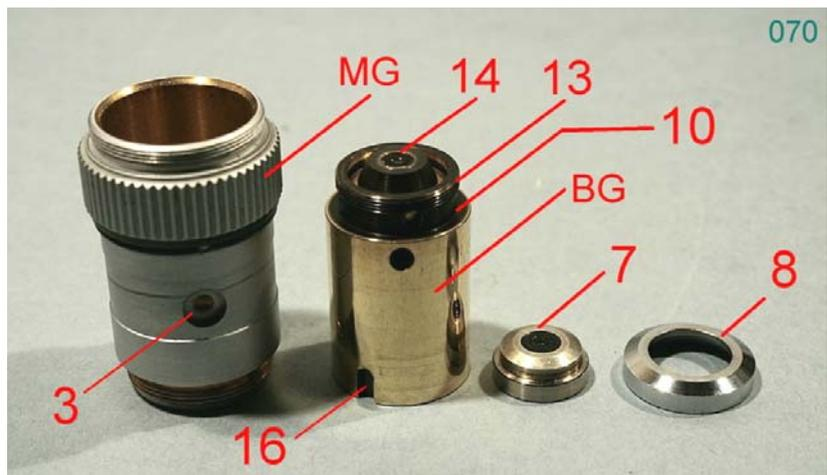
NB: da notare una breve scanalatura (16) presso l'orlo superiore del barilotto generale. In essa deve impegnarsi la punta di un chiodino in plastica bianca (4 nella fig. 1182) che va infilato nel foro 3, già visto. Il chiodino serve ad impedire che il barilotto generale possa ruotare su sé stesso.
