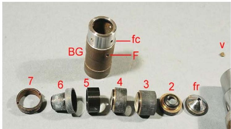
Fig. 1200 – Osservando più da vicino, appare chiara l'ossidazione non solo sulla superficie esterna dei barilotti singoli, ma anche all'interno del barilotto generale.
