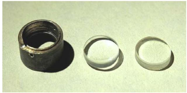
Fig. 1210/11 – I membri 3 e 4 completamente smontati. Un energico lavaggio con xilolo ha eliminato i residui di adesivo ed un paziente lavoro di raschietto ha tolto gli strati di ossidazione.<sup>3</sup>
