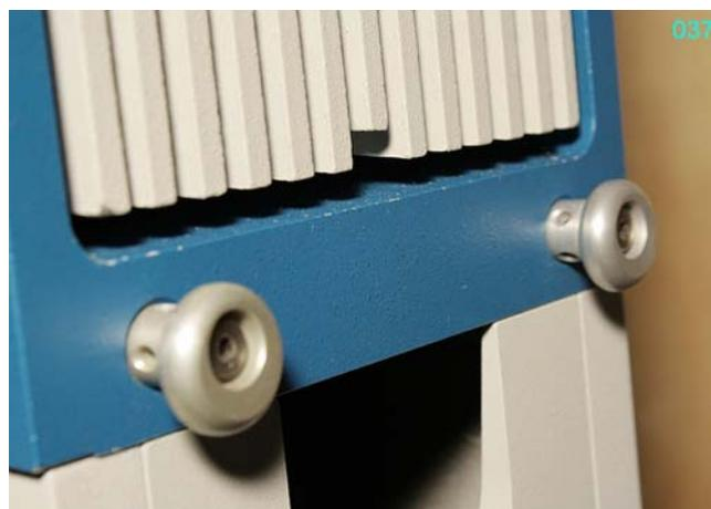
Fig. 1160 (a destra) – Sulla faccia nascosta della lampada sono visibili i due punti d'appoggio per i pomelli superiori –3 delle figure precedenti. Tali "punti d'appoggio" (–8) sono costituiti da blocchetti in alluminio con un solco inclinato che serve ad accogliere la testa dei pomelli stessi.
