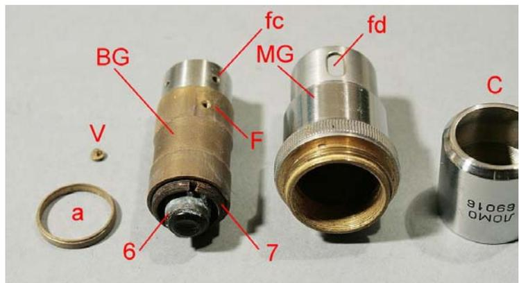
Fig. 1199 – Il pacco lenti è composto da una serie di barilotti con un sottile anello distanziale (non visibile) fra i barilotti **fr** e 2 ed un lungo distanziale (5) fra i barilotti 4 e 6.
