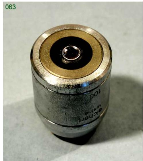
Fig. 1171 – Su tutte le superfici esterne dell'obiettivo è visibile una corrosione fatta di puntini giallastri (attacco chimico?). L'anello superiore giallo è un anello in ottone, cromato internamente, che funge da specchio paraboloidico.
