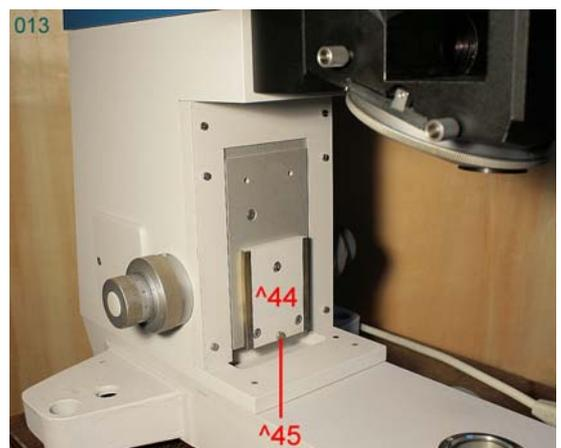
Fig. 1145 (a sinistra) – Il tavolino comporta una piastra scorrevole in direzione Est-Ovest (X) con un ampio foro quadrato. Essa è portata da una piastra sottostante (Y) che assicura la corsa Nord-Sud. Questa a sua volta scorre sulla piastra fissa ^47, che è fermata da quattro viti al supporto ^48.
