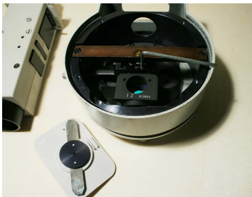
Fig. 69 – Lo smontaggio del cubo porta-filtri a mezzo della chiave a brugola presente all'interno dello sportello visibile nella figura precedente (CB).
