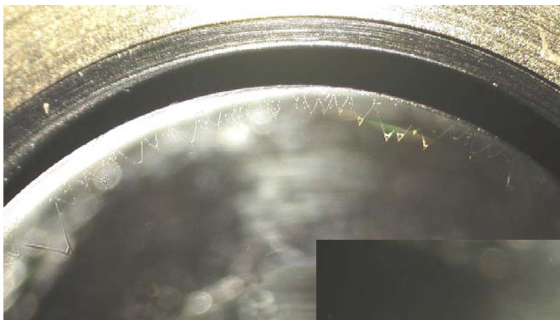
Fig 804 e 805 – La superficie di contatto fra le due lenti del doppietto 4: diverse alterazioni, ma solo sui bordi.
