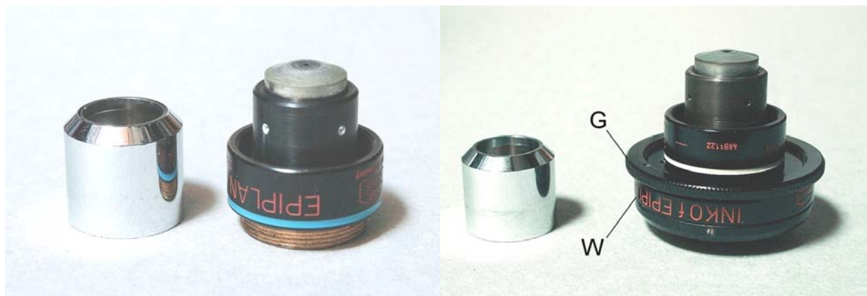
Fig. 750 – Si tratta di due obiettivi con diversa lunghezza di parfocalità: 22 mm per quello di sinistra, 33 mm per quello a destra. La porzione di maggior diametro dell’obiettivo a destra (W) contiene un braccio rotante che porta un prisma di Wollaston. L’orlo sporgente di questa parte (G) è godronato e girevole in modo da comandare la rotazione del braccio.
