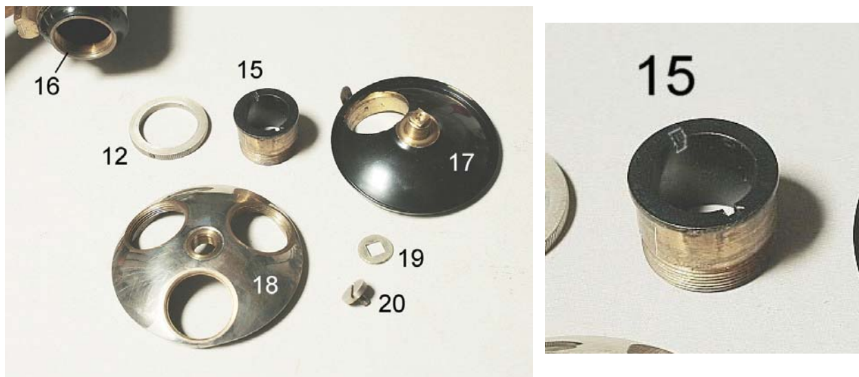
Fig. 779 – Il revolver completamente smontato, ed un dettaglio dell'anello 15, che mostra i due tagli periferici.
