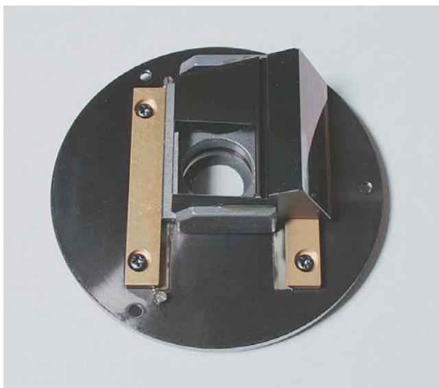
Fig. 735 – Se dal tubo si svita la piastra circolare visibile nella figura precedente, appare la parte inferiore dei due tubi: a sinistra quello diritto, per la fotografia; a destra quello bioculare inclinato.
