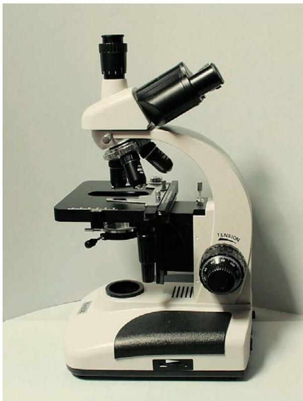
A pag. 2, quinta riga dal basso, alla voce 4, si parla di “conjugate distance”, ma si tratta della “lunghezza equivalente” del tubo, che tiene conto della presenza delle parti ottiche intermedie (in particolare, nel nostro caso, di un sistema Telan + i prismi), e non è la distanza “between object and image”, bensì la distanza equivalente fra battuta d'obbiettivo e battuta d'oculare.
