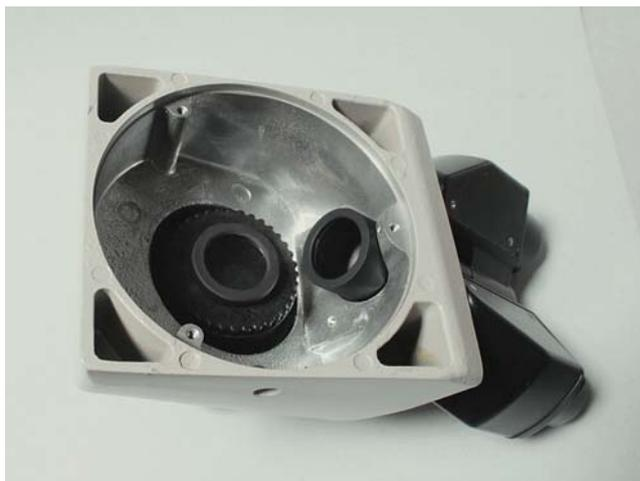
Fig. 736 – Il tubo diritto verticale è semplicemente avvitato nella parte superiore della scatola. Inferiormente a tale tubo (in alto nella figura perché il tubo diritto è stato rovesciato), si vede un anello ad orlo dentato, avvitato nella porzione cilindrica nera, al centro della quale è incastonata una delle lenti superiori del Telan.
