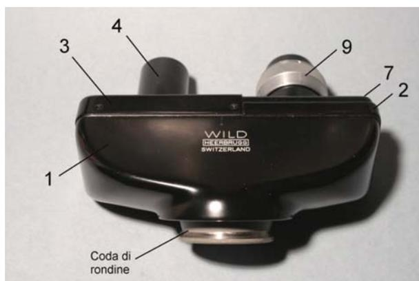
Fig. 720 – La prima cosa da fare è svitare la boccola destra (4); ciò fatto, si può smontare il coperchio 3, che era tenuto fermo anche da quattro piccole viti nere (sotto, in centro).
