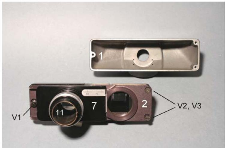
Fig. 723 – Voltando all'insù la piastra base 2, appare il gruppo dei prismi ed è possibile pulire tutte le superfici ottiche. Al massimo, sarà utile spostare la boccola 9 tutta verso l'esterno.
