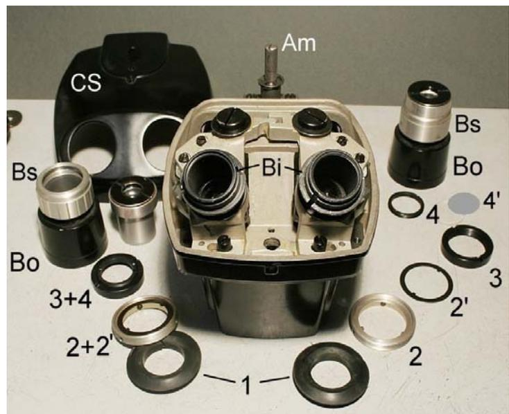
Le boccole porta-oculari (Bo) portano superiormente un filetto sul quale si avvita un anello
