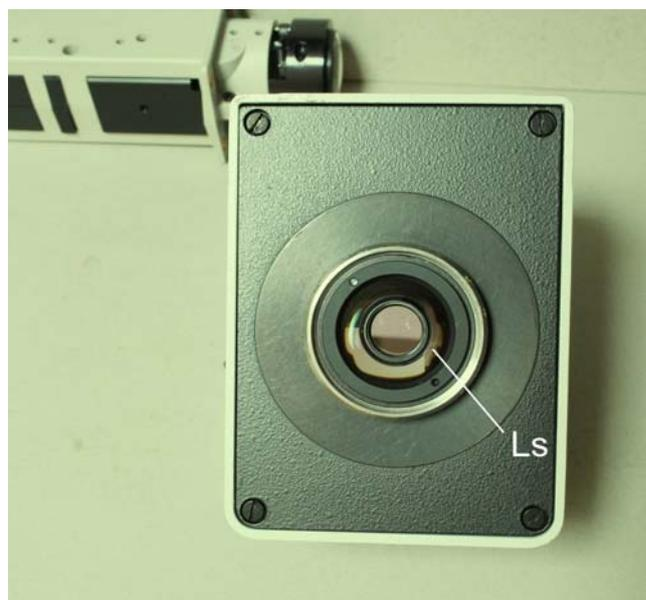
Fig. 674 – Secondo lo schema di fig. 671, il fascio illuminante che incide sull’obbiettivo deve essere convergente a livello del foro del revolver e poi divergente. Un cartoncino verticale posto sotto il revolver (in assenza dell’obbiettivo) lo rende visibile. Si confronti con la fig. 677 bis.
