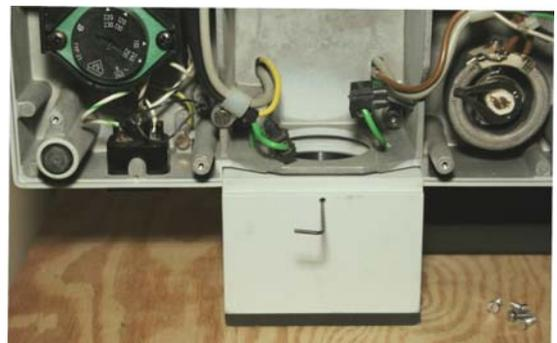
Il grano è un M3 a brugola, e lo si allenta infilando nel foro citato una chiave a brugola da 1,5 mm, come si vede nella fig. 635. La punta del grano deve impegnarsi in un foro praticato presso
