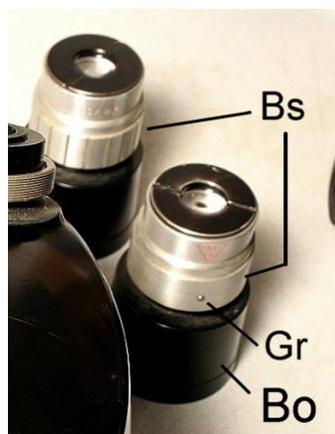
Fig. 694 – Le boccole porta-oculari, smontate. (Particolare della fig. 692).
