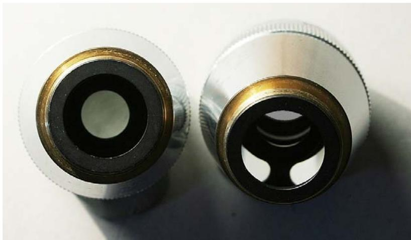
Se si tiene l'occhio sull'asse ottico (a sinistra in fig. 672), il diaframma superiore (1 nelle figure precedenti) lascia vedere solo la lente emergente dell'obiettivo. Per vedere il condensatore (lente L e specchio 7', fig. 671) occorre inclinare parecchio l'obiettivo (a destra, fig. 672). Questo spiega perché, in fig. 671, i raggi principali del fascio illuminante incidente (Fi in figura) sono disegnati come fortemente convergenti e poi divergenti.
