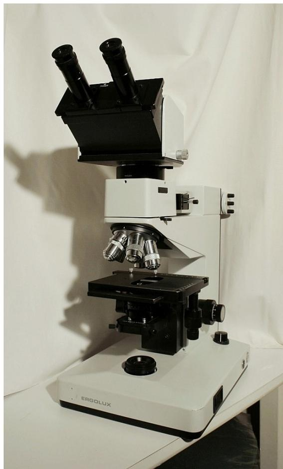
Lo stativo è fornito di una microlampada che si può fissare, con una sola vite, sia in posizione “epi”, come in fig. 600-601, oppure in basso, in posizione “dia”, come previsto dall’analogia finestra (5) visibile in fig. 601.
