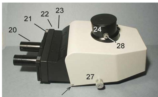
Figg. 646 e 647 – Il tubo porta-oculari. Le boccole porta-oculari (20) sono portate da due guide trasversali (21) che consentono di variare la distanza pupillare. Il movimento delle guide non altera la lunghezza del tubo poiché un sistema di leve interne (29 in fig. 648) fa spostare il blocco delle guide col relativo coperchio (21 + 22) lungo l'asse ottico; questo blocco infatti è mobile rispetto alla piastra di base (33, fig. 648 e 649) tramite due guide a sfere (31 + 32).
