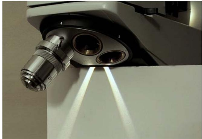
Per avere una “prova del nove” di questo schema, basta ricreare il fascio illuminante a ritroso. Si appoggi l’obbiettivo con l’asse orizzontale sul tavolo; si ponga nel primo fuoco dell’obbiettivo il filamento concentrato di una lampadina a bassa tensione o un LED e, dalla parte emergente dell’obbiettivo, il solito cartoncino passante per l’asse (fig. 675).
