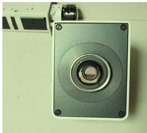
Fig. 622 (a destra) – Lo specchio 40 + 41 è fisso. Ciò significa che, in posizione "fondo scuro", si perde almeno il 50% del fascio formatore d'immagine. Questa perdita è inevitabile in fondo chiaro, mentre in fondo scuro si potrebbe evitare rendendo il semiriflettente 40 estraibile, come avviene in tanti altri strumenti.
