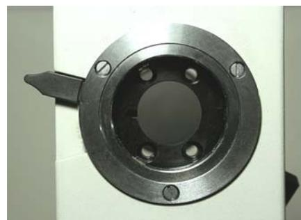
Fig. 625 – L'estremità del braccio, da sotto, con la superficie d'appoggio del revolver (3). Tolta la piastra 4 (due viti), appare il meccanismo di comando e di arresto del revolver, meglio visibile nella figura seguente.
