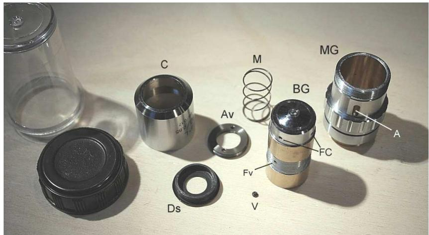
Fig. 375 – L’anello a due tacche At si svita dall’alto del barilotto generale e si libera così l’intero “pacco lenti”.
