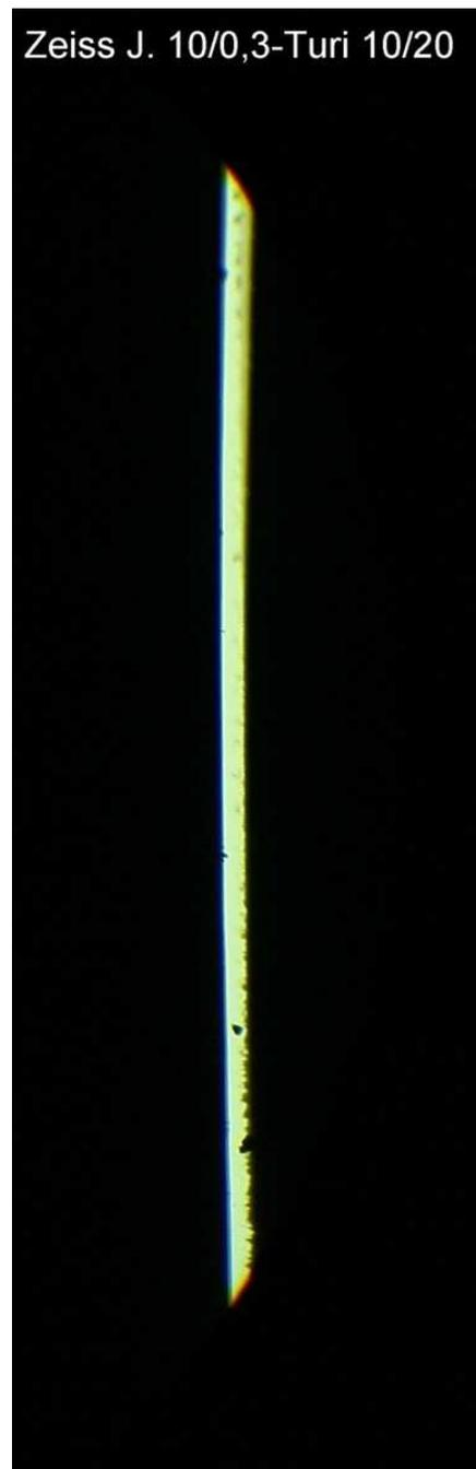
Fig. 415 e 416 – I due bordi della fessura sembrano acromatici, e quindi la CVD è corretta, con un oculare compensatore “medio”: a sinistra un classico Galileo HC 10 × , negativo; a destra, un moderno WF 10/20 $\infty$  (Turi), positivo.
