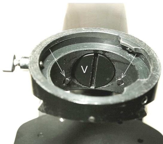
Fig. 427 – Il blocco revolver + anello di appoggio del tubo è fissato all'estremità del braccio da una grossa vite (V). Estraendo le due spine (freccette bianche), allentando la vite ed introducendo qualche "spessore"<sup>6</sup> in un punto o nell'altro delle due superfici a contatto, oppure semplicemente ruotando l'anello rispetto alla vite, si può variare a piacere l'inclinazione del blocco.
