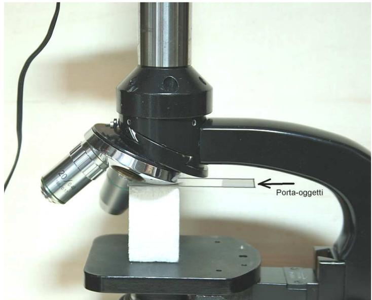
Fig. 422 – Inizialmente, l'immagine visibile nell'oculare dell'auto-collimatore mostra un'inclinazione del revolver che devia dal parallelismo (rispetto alla superficie di riferimento del braccio) di 19 minuti primi in orizzontale, e circa 13 in verticale. Si può fare di meglio.
