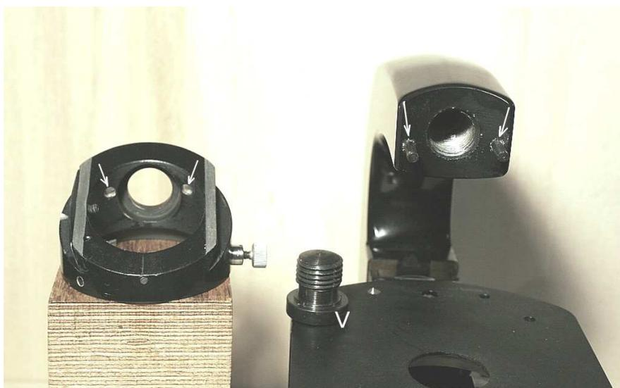
In questo stavivo, vi è la possibilità di muovere il solo revolver, che in questo caso è estraibile. Infatti, esso è fissato per mezzo di quattro viti ad una piastra che porta la sede per una coda di rondine: il "maschio" di quest'ultima sporge dalla parte inferiore dell'anello sporgente all'estremità del braccio (fig. 426).
