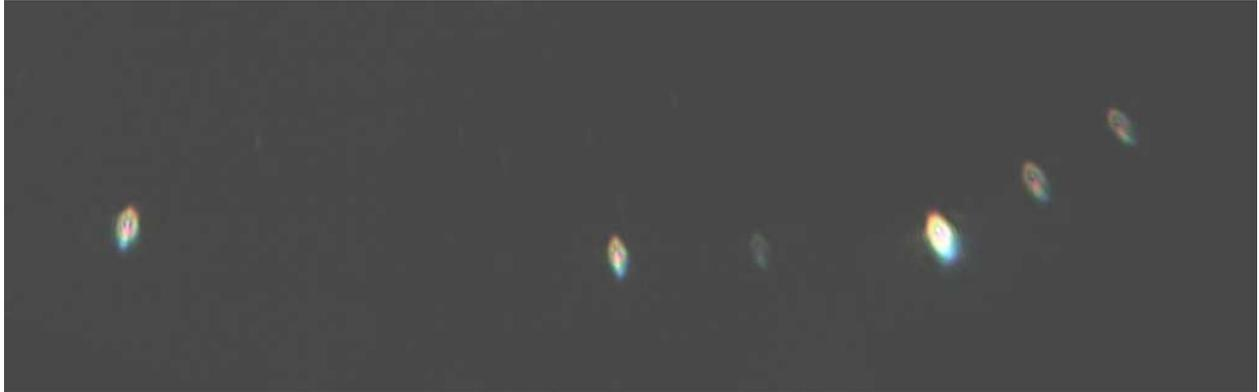
Fig. 411 – Ai margini del campo dell'oculare Zeiss O. Kpl W 10 × /20  $\infty$ , la coma è evidente. Non dovrebbe succedere in un obbiettivo apocromatico.
