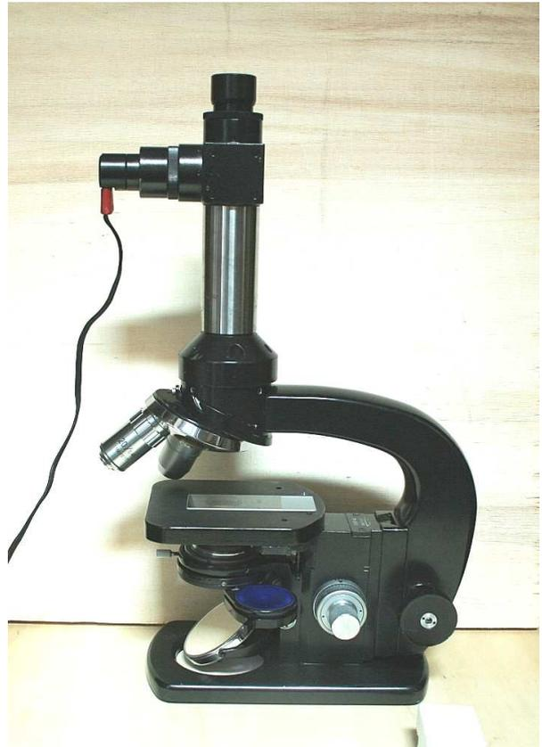
Fig. 425 – La superficie superiore del tavolino non è perpendicolare all'asse del tubo ovvero: il tavolino non è parallelo alla superficie d'appoggio del tubo stesso. Qui, l'errore di allineamento ammonta a 29' in orizzontale e 17' in verticale. Troppo.
