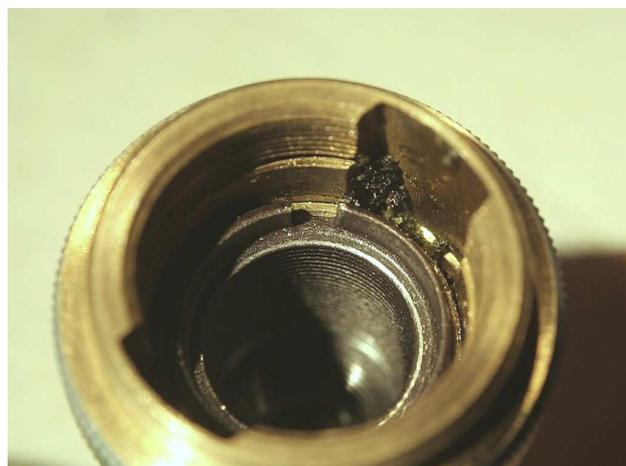
Con mezzi meccanici più energici (anelli in para, ecc.) è stato possibile smontare tutto; la difficoltà è nata dal fatto che i pezzi inferiori (barilotto frontale e pezzi contigui) erano letteralmente cementati da un materiale bruno durissimo (fig. 403, in cui si vede il barilotto
