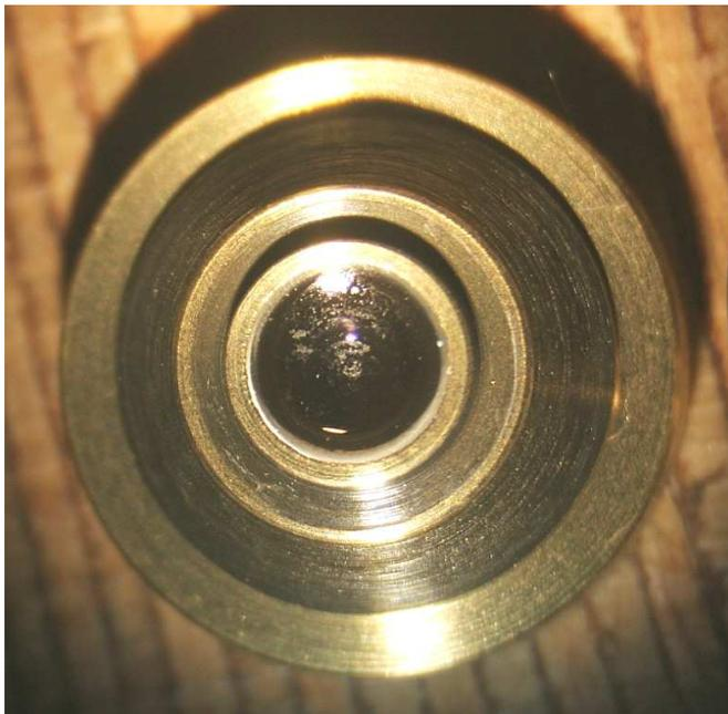
Fig. 379 – La superficie inferiore del membro B1 posto subito sopra la frontale (F). Tale superficie, allo scopo di minimizzare la sferica, viene tenuta ad una distanza minima dalla superficie interna della frontale.
