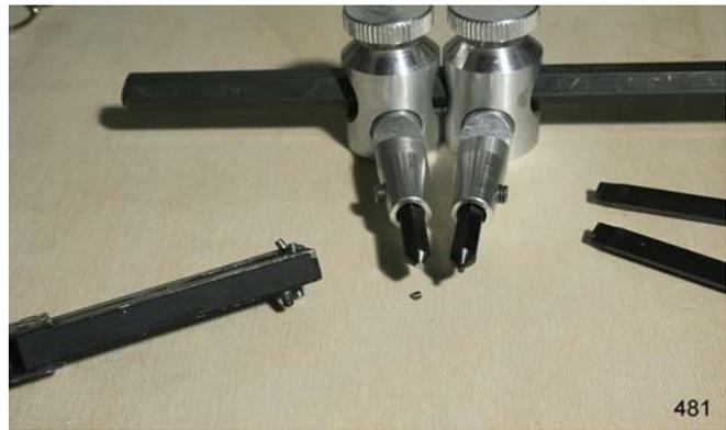
Dopo aver intrapreso la riparazione degli attrezzi fuori uso, spunta il dubbio che l'anello filettato sia stato sigillato. Nel caso di adesivi acrilici, i rimedi sono due: il calore (oltre 200 °C) o l'alcool.
