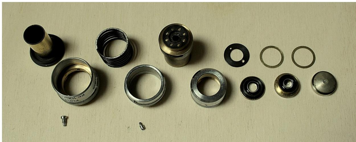
Fig. 285 – Il diaframma superiore (il primo pezzo a sinistra) serve da guida per il movimento a pompa (l'obiettivo è molleggiato). Si notino, a destra, i due anelli distanziali, di diverso spessore. Il diaframma ad iride è stato fotografato non disassemblato poiché è identico a quello dell'obiettivo 40. La vite in basso a sinistra è quella che fa da guida per il movimento a pompa. Quella più piccola, verso il centro, collega l'anello esterno girevole col diaframma.
