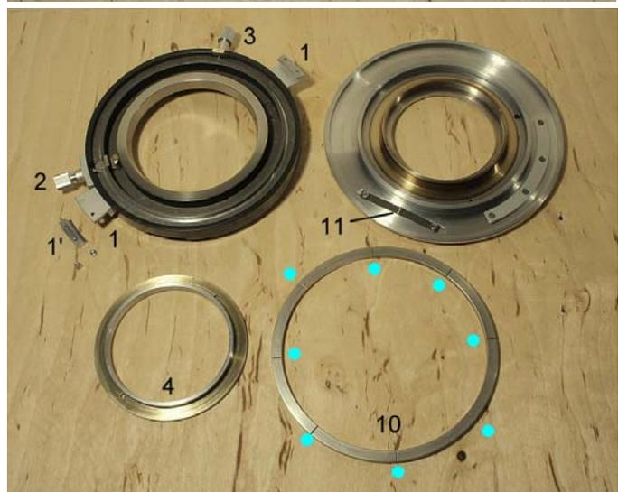
Un guida-oggetti applicato si fissa al tavolino con una vite e la sua posizione è definita da due spine. Le manopole per i due movimenti ortogonali sono del tipo normalmente usato nei microscopi polarizzatori: discoidali, ribassate, rivolte in alto, in modo da non ostacolare la rotazione del tavolino per 360° ed evitare urti cogli obbiettivi.
