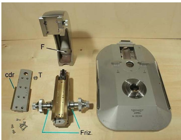
Fig. 273 – Sulla destra, le due molle di alleggerimento della macrometrica (meglio visibili nella figura seguente, ripresa dall’altra parte del blocco).
