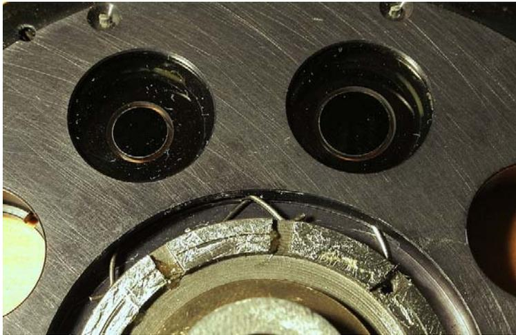
Fig. 279 – Il disco, da sotto. Si vedono le estremità di due mollette semicircolari, parzialmente sovrapposte. Le mollette spingono sul bordo del cilindro porta-diaframma: due oggetti di forma arrotondata che non definiscono bene la loro posizione reciproca. Questo significa che la posizione laterale dei diaframmi non è ben definita e la loro centratura sarà instabile e non ripetibile.
