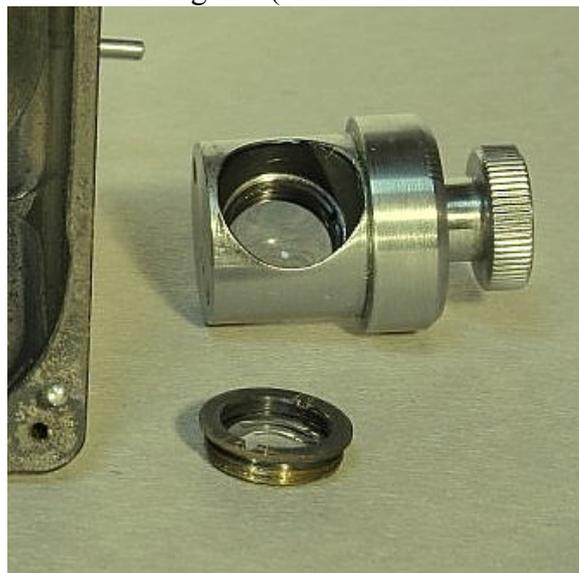
Fig. 194 (sopra) – L'illuminatore episcopico. La piastra che porta il prisma interno si toglie dopo aver svitato quattro piccole viti; occorre però anche vincere la resistenza di due spine che si trovano in posizione diagonale.
