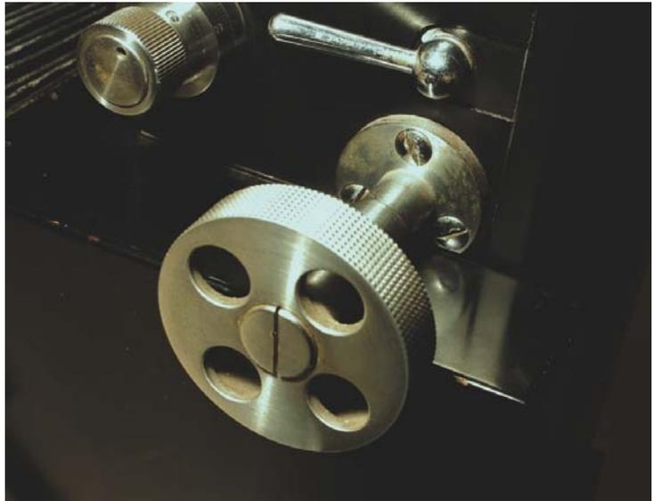
Fig. 211 – La guida a coda di rondine per la micrometrica, ricavata dalla colonna. In basso si vede la ruota dentata che, mossa dalla vite perpetua coassiale con le manopole, fa ruotare una camma con essa solidale (C).
