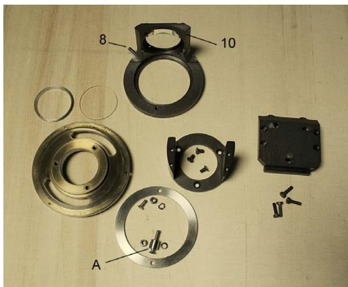
Fatto questo, si è smontato il cilindretto 9 di fig. 236 e si è notato che esso era già fissato in posizione di minimo, non solo, ma era stato limato per assottigliarlo ancora (fig. 287). Anche togliendolo del tutto, però, la corsa della lente era ancora scarsa.
