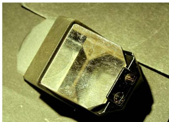
Fig. 196 (sopra, a destra) – Un attacco da funghi su una superficie di vetro può essere reversibile se in fase iniziale.
