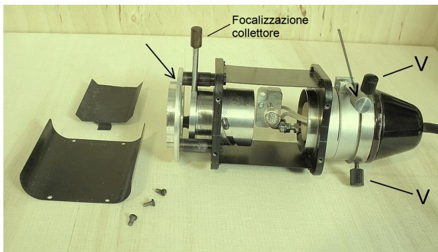
Alla lampada, davanti al porta-filtri originale, è stato fissato un anello in alluminio (freccia semplice in fig. 164) con sporgenza del diametro di 44 mm, per l'inserimento nell'anello porta-lampada (1) visibile in fig. 166.
