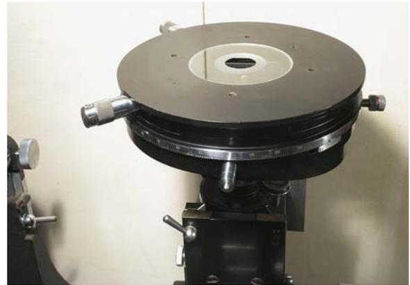
Fig. 174 – Il blocchetto (1), tramite una grossa vite prigioniera, si fissa al foro 8 per coprire le viti 7. Le manopole graduate (2) con scala micrometrica (3) servono ai movimenti trasversali del tavolino. Le viti 4 e 6 servono a centrare l'asse di rotazione del tavolino rispetto all'obiettivo. (5) è la scala graduata (un grado sessagesimale per tacca) per la rotazione; il relativo nonio non è visibile poiché si trova dall'altra parte.
