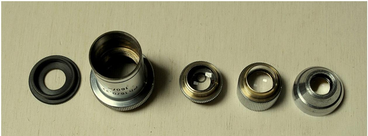
Fig. 283 – I due elementi superiori si avvitano sul barilotto della frontale.
