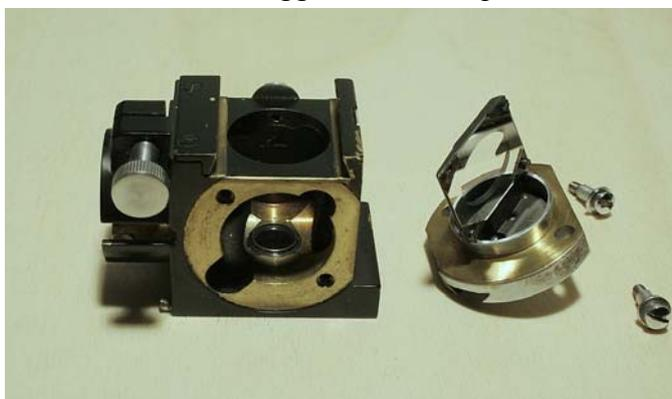
Come si vede, il foro sulla parete porta due incavi che consentono di estrarre lo specchio, che è più lungo del diametro del foro. Sopra, la guida per la slitta dell'obiettivo. A sinistra, l'innesto per l'illuminatore (8).
