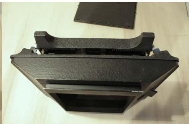
Naturalmente, il cassetto tenderà a richiudersi; per bloccarlo in posizione di apertura occorre, mentre si tiene sollevata la sua parte superiore, spingere verso sinistra le due barre cromate indicate con 3 in fig. 176. Ognuna di tali barre (3), in virtù di due asole inclinate, invisibili dall'esterno per essere coperte da una bandella verniciata in nero, si sposta verso il centro, in modo da infilarsi sotto la parte superiore del cassetto.
