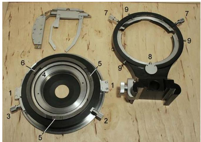
Fig. 267 – Il tavolino smontato. Si vede il nonio di sinistra che è stato smontato (1') per poter separare le due parti. L'anello 10, che si può bloccare con la vite 2, presenta 8 tacche, segnate con un pallino verde, che si impegnano con la piega centrale della molla 11.
