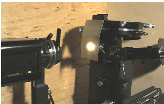
Fig. 168 – Ponendo un foglio di carta “da lucidi” davanti all'ingresso dell'illuminatore, si può visualizzare l'immagine del filamento e, simultaneamente, l'orlo dell'illuminatore, che apparirà come un anello chiaro (vedi la foto sotto).
