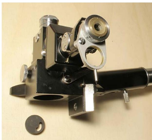
Naturalmente, questo polarizzatore è efficace solo se, al di là del semi-riflettente (sotto il “cubo”), si pone un altro polarizzatore, un “analizzatore”, in “posizione incrociata”.
