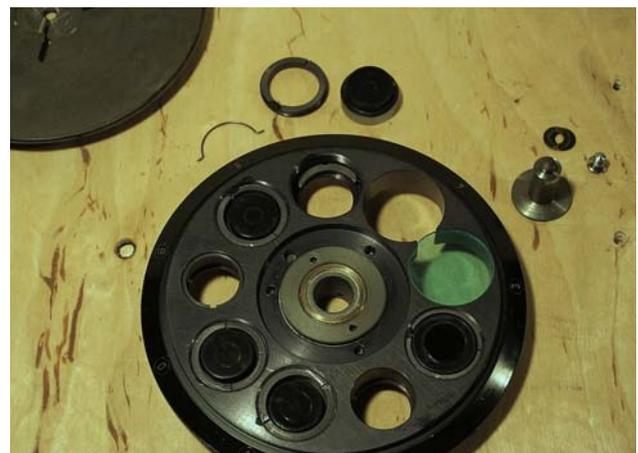
Fig. 277 – Tolto il disco, rimane solo il “fondo” con il diaframma d'apertura. Il blocco centrale (a destra, rovesciato) è mosso dalle due viti di centratura (si vedono sporgere le loro teste godronate) e da una punta molleggiata (A, visibile inferiormente al foro centrale). In questo modo, azionando le viti, il blocco centrale con il disco che gli ruota attorno si muove in due direzioni orizzontali. Così si spostano simultaneamente tutti i diaframmi anulari.
