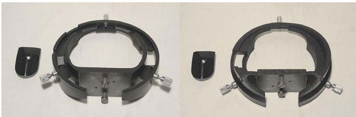
Il sotto-tavolino si avvita sul montante (in alto nella fig. 171) per mezzo delle due viti che si vedono in basso nella figura 170 e viene allineato dalle due spine visibili in alto nelle figg. 171 e 172.
