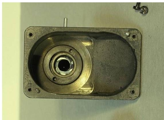
Comunque, col diaframma di campo smontato, appare un barilotto contenente una forte lente divergente (vedi in basso nella fig. 193 e (22) nella fig. 198). Va notato che tale lente si avvita sul fondo dell'alloggiamento del prisma (23 in fig. 198) e, sporgendo nella cavità che alloggia il
