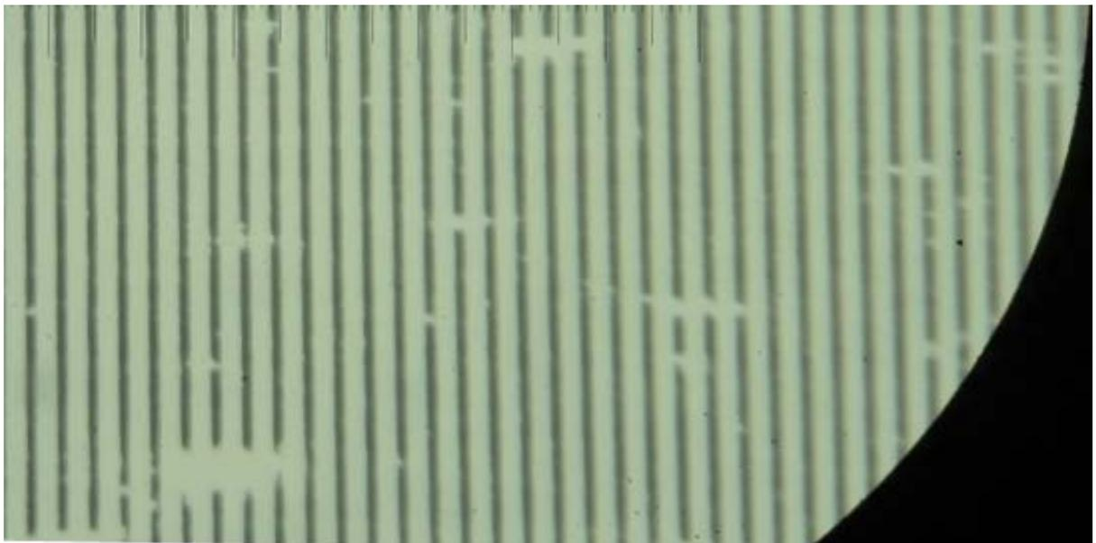
Fig. 142 – Il contrasto non è elevato. Il fuoco non è ottimale fino ai bordi; ai margini del campo le righe appaiono con bordature colorate. Il colore è bluastrò nei margini delle righe scure dirette verso il centro del campo, e ciò è segno di un'insufficiente correzione della CVD. Colpa dell'oculare.
