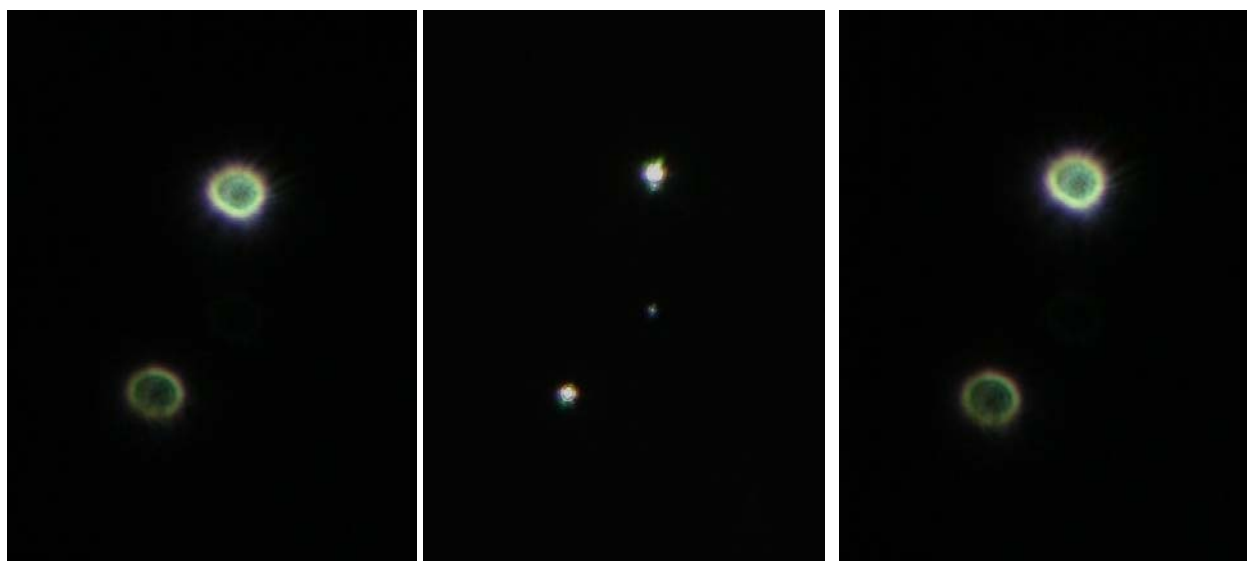
Fig. 108 – Lo star test con l'obiettivo montato su uno stativo con "ottica all'infinito" (lente di tubo), in assenza di lamella ( d = 0 ). Si noti che, nella foto di miglior fuoco (al centro) compare una debole centrica, in mezzo alle altre due, che scompare nelle foto sfocate per il fatto di essere troppo debole. (021-024-0,28).
