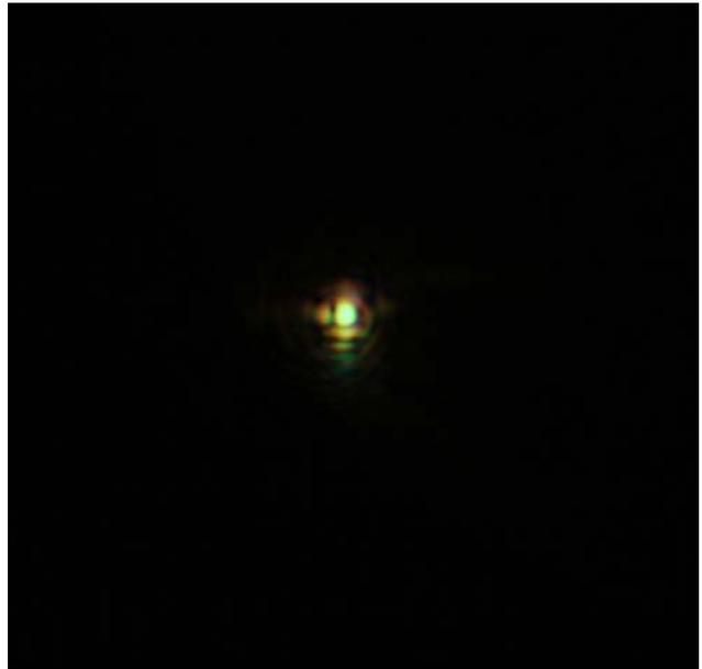
Fig. 4 – Focheggiando leggermente sopra e sotto il miglior fuoco, compaiono le focaline astigmatiche. Poiché tutte queste figure (tranne l'ultima) sono riprese al centro del campo, si tratta di **“astigmatismo in asse”, presumibilmente dovuto ad errato allineamento (inclinazione) di una delle lenti.** (889)
