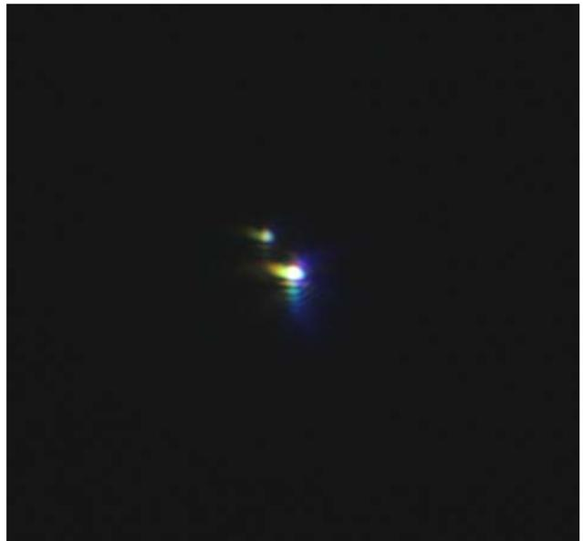
Fig. 6 e 7 – Dissimmetria nelle centriche sopra e sotto il miglior fuoco: piccolo residuo di sferica. Nella figura a sinistra vi è un accenno di “immagine ad anelli”. L’interpretazione di queste figure è resa difficile dal residuo di astigmatismo e coma rilevato nelle figure precedenti.
