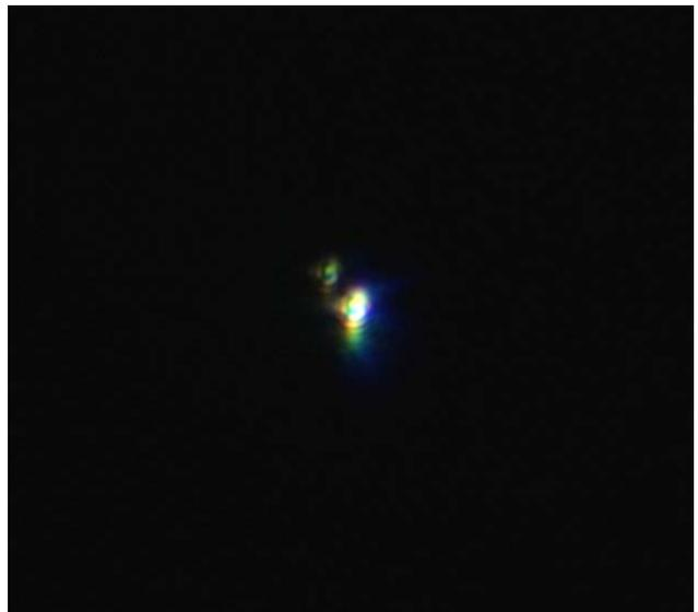
Praticamente impossibile porre rimedio senza la sostituzione della lente difettosa.
