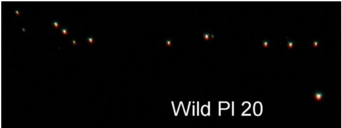
Il Lomo apocromatico 20/0,65, non va male, ed il residuo di coma simmetrica è proprio trascurabile. Le centriche appaiono più grandi perché più luminose ( $NA = 0,65$ ).
