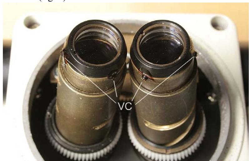
Nelle due figure seguenti è visibile il sistema della doppia camma che muove simultaneamente e non linearmente due dei vari membri dell'obiettivo zoom, nonché il sistema
