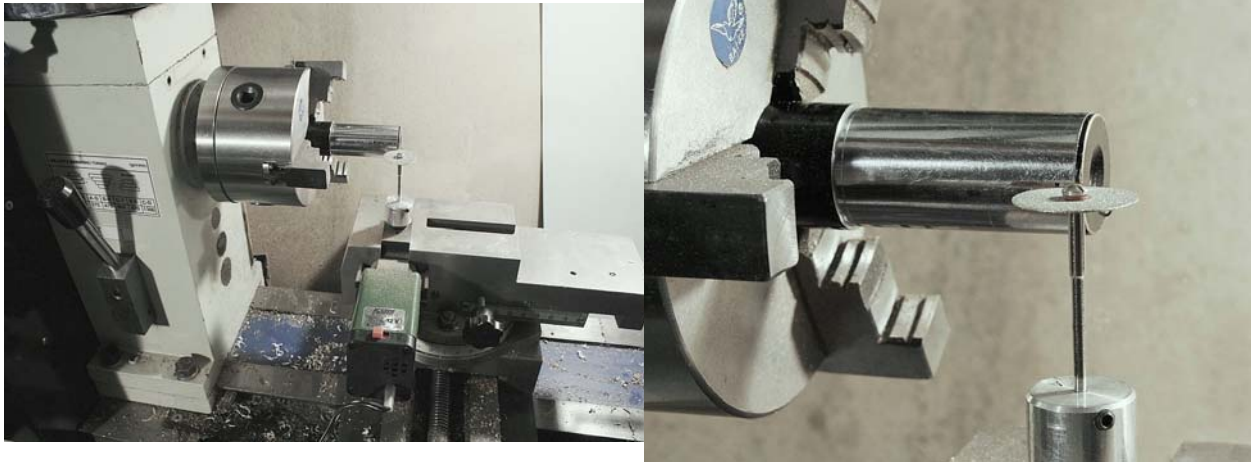
Fig. 4 – Il piazzamento del tubo esterno. Facendo riferimento alle tre ganasce del mandrino, non è difficile portare davanti al disco abrasivo tre punti del tubo a 120^\circ l'uno dall'altro.
