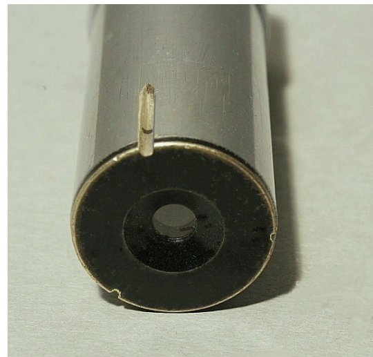
Fig. 4 – Il piazzamento del tubo esterno. Facendo riferimento alle tre ganasce del mandrino, non è difficile portare davanti al disco abrasivo tre punti del tubo a 120^\circ l'uno dall'altro.
