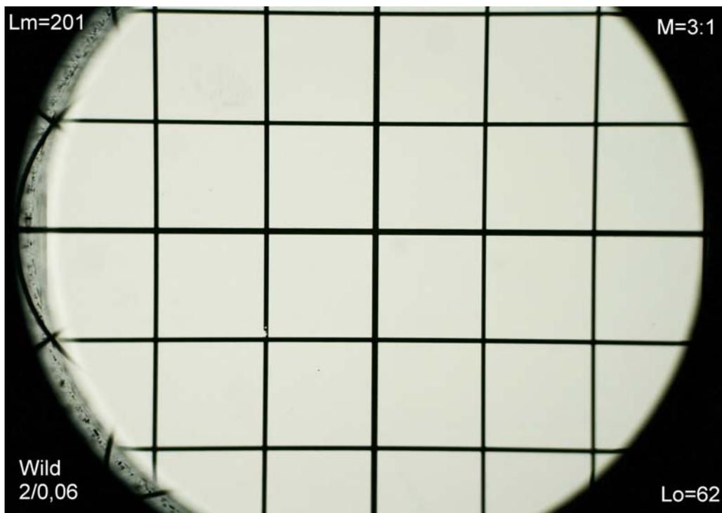
Fig. 9 – L'obiettivo di cui sopra, utilizzato con un tubo di lunghezza  $L_m = 201$  mm. La lunghezza di parfocalità si è ridotta ( $L_o = 62$  mm) e l'ingrandimento è salito a 3:1. L'immagine è ancora ottima.
