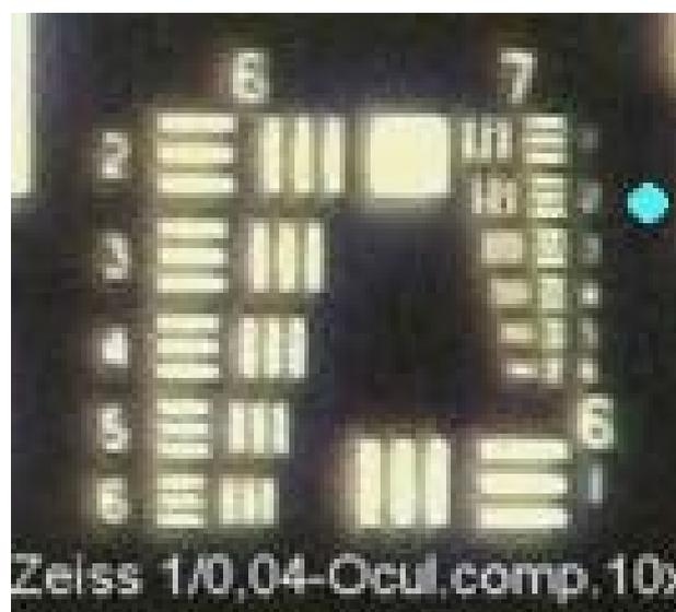
Fig. 33 a/b – Obiettivo Zeiss 1 / 0,04. Risoluzione teorica  $d = 0,6 \lambda / 0,04 = 7,5$  micron circa. Risoluzione misurata (figura 2 del gruppo 7 = 6,9 micron). Va notata la pessima definizione (aberrazione sferica), inaccettabile in un obiettivo che dovrebbe essere planare e semi-apocromatico (e non è né l'uno né l'altro).
