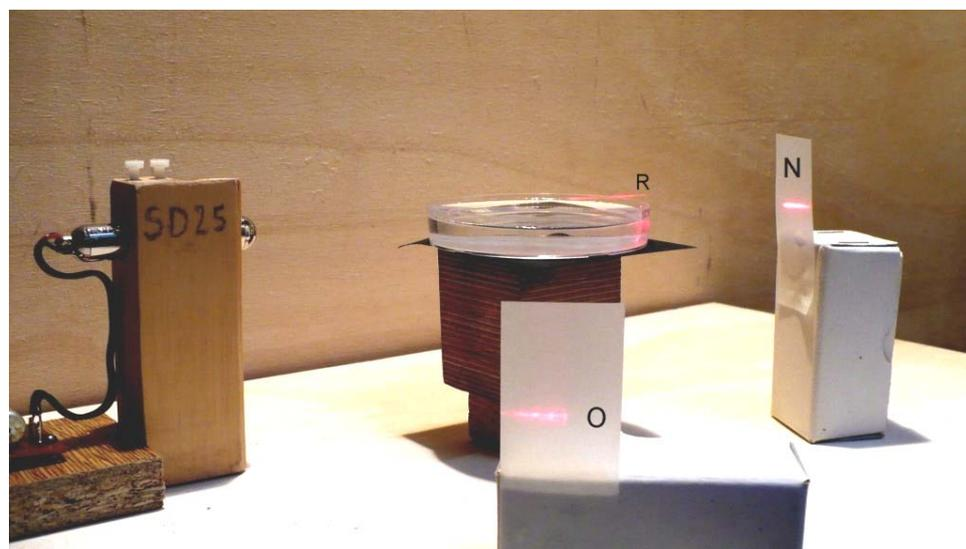
Con questa realizzazione è dunque possibile verificare sperimentalmente quanto enunciato sul piano teorico nell'articolo generale citato all'inizio o sui trattati di fisica. Si tratta di applicare le leggi della rifrazione e della riflessione ad un oggetto trasparente sferico, tenendo conto dell'indice di rifrazione e della lunghezza d'onda della radiazione utilizzata.
