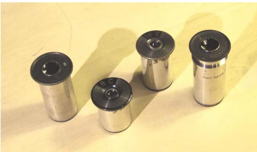
Oculari di fine '800. Da sinistra a destra: "2", (6,4 ×, Huygens, Acromatico). 8C (12 ×, Compensatore, negativo). 18C (26 ×, Compensatore, positivo). Zeiss 2 Mikrometer (6 ×, Huygens regolabile)(l'unico non anonimo).
