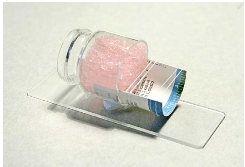
Fig. 7 – Estratto dal flacone, a colla indurita, si ottiene il semicilindro graduato, che si può fissare con un po' di mastice ad un porta-oggetti.
