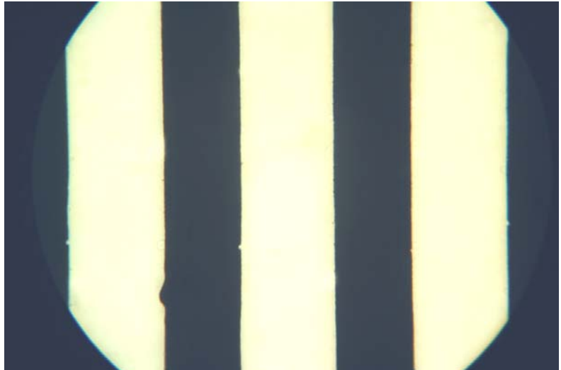
Fig. 20 – Un reticolo a righe opache produce un'immagine a buon contrasto. Ci si può assicurare.
