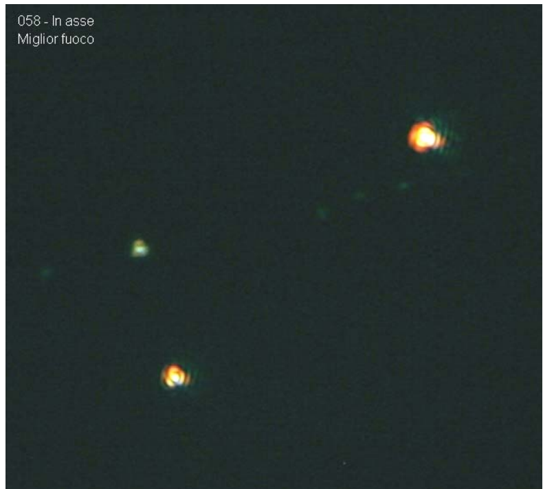
Fig. 21 – Lo star test rivela delle centriche ragionevolmente simmetriche, rotondeggianti: questo significa che la lente frontale è centrata.
