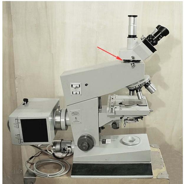
Fig. 22 – Anche qui, un tubo intermedio col solito sandwich del Telan, intramezzato da analizzatore, lente di Amici, ecc. Già citato nell’articolo precedente.
