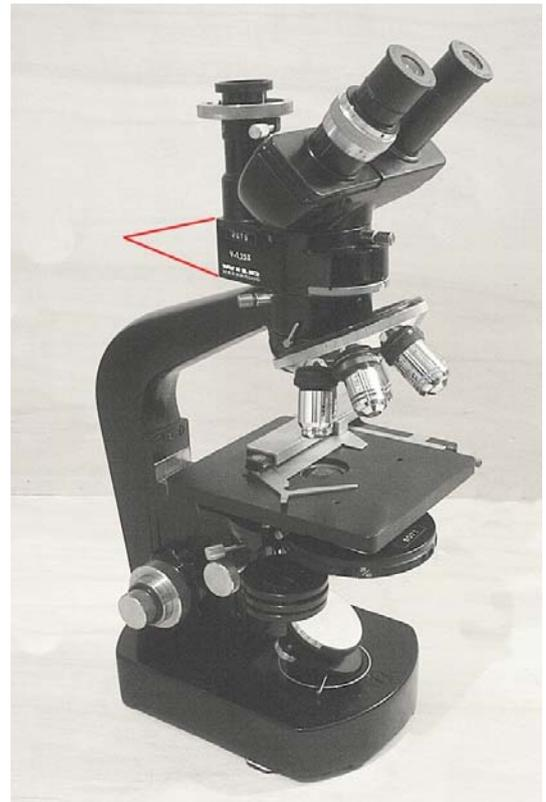
Fig. 25 (a sinistra) – La porzione verticale del tubo (B) è più lunga di quella inclinata monoculare (A). La lunghezza totale è corretta ( $L_m = 160 \text{ mm}$ ).
