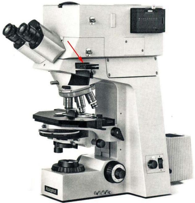
Fig. 43 (sotto) – Tanto per stare nel complicato, un tubo intermedio per l’interferenza, prodotto dalla Zeiss di Jena dal 1965 fino ad oltre il 1990, contiene la sua brava lente di Amici (13).
