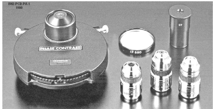
Fig. 52 – Ad uno stativo di questa mole sembra che nulla debba mancare, ma la lente di Amici non è prevista, ed il costruttore propone il solito microscopio ausiliario CT.
