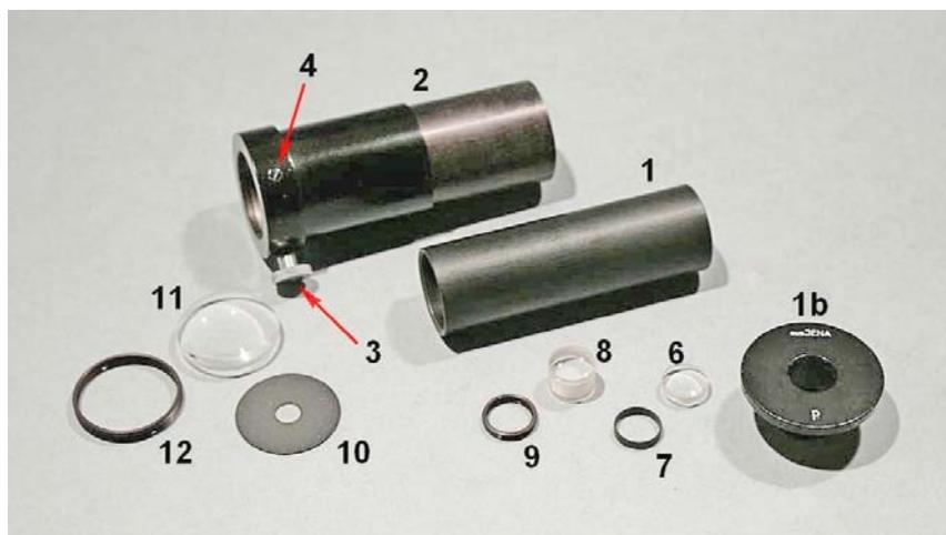
L'obbiettivo<sup>9</sup> è formato da una lente semplice piano-convessa (11) di cui si usa solo la zona centrale essendo essa preceduta da un disco forato (10); la lente 11 è fissata anch'essa da un anello a vite (12).
