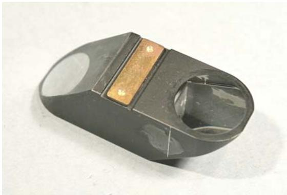
Fig. 31 (sopra) – Il prisma superiore, come l'altro, porta una fossetta in cui alloggia un piastrino. In quest'ultimo si vedono due piccoli incavi in cui alloggiavano le punte dei grani 6.
