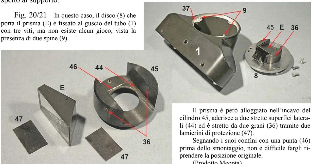
Il prisma è però alloggiato nell’incavo del cilindro 45, aderisce a due strette superfici laterali (44) ed è stretto da due grani (36) tramite due lamierini di protezione (47).
