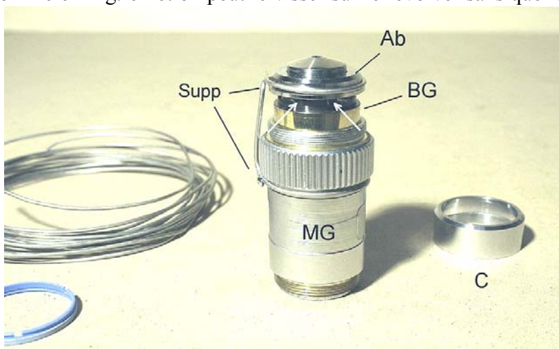
Fig. 64 - L'objectif de l'illustration précédente, remonté sans la bague qui retient BG (C), mais avec la cagette "Supp", qui permet d'accéder aux trous de centrage (fléchettes blanches).
