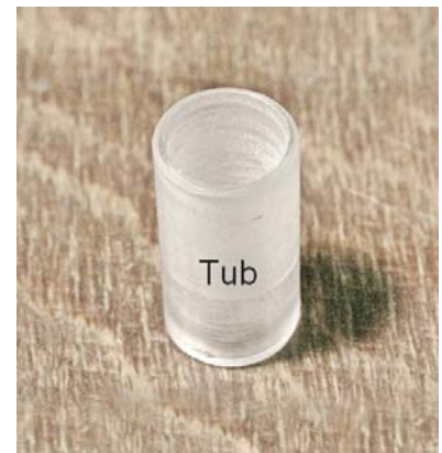
Fig. 44 (à droite) - Avec un tour, il n'est pas difficile de réaliser ce cylindre en Plexiglas ou en PVC, percé en centre.
