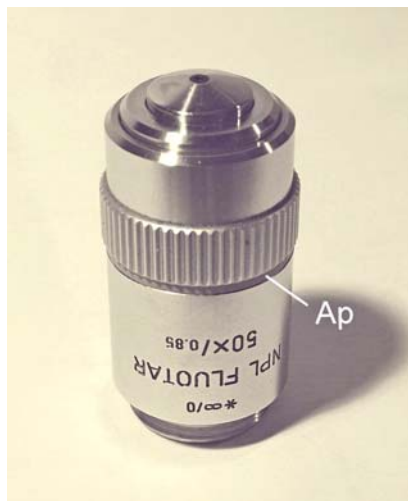
Fig. 50 a/b - Objectif Leitz "50/0,85 NPL Fluotar - \infty/0 ". Il s'agit d'un objectif épiscopique, calculé pour travailler avec la "deuxième conjuguée infinie" (" \infty ") et sans lamelle (" 0 ").
