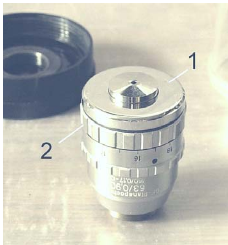
Fig. 51 et 52 - Objectif Zeiss Jena GF Plan-apochromat 63/0,90 "à correction". Premier étage du démontage.
