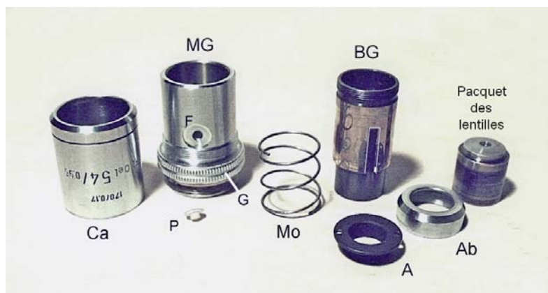
Fig. 49 - Objectif Leitz 54/0,95 Oel (HI). Au lieu de la petite vis V des illustrations précédentes, le barillet BG est guidé dans sa course par un petit clou en plastique à forme de champignon (P) qui s'enfile dans le trou F et glisse dans une fente présente sur le barillet BG.
