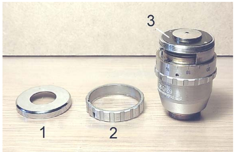
Fig. 51 et 52 - Objectif Zeiss Jena GF Plan-apochromat 63/0,90 "à correction". Premier étage du démontage.
