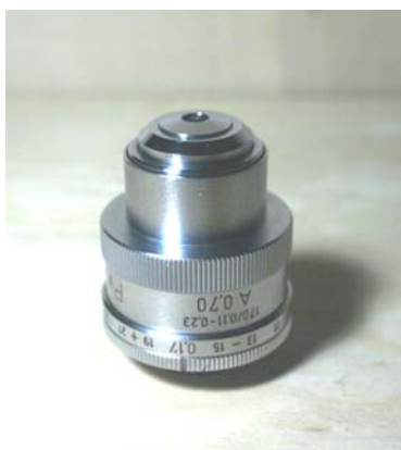
Fig. 56 - Objectif Leitz 40/0,70 à correction, de phase, à forte distance de travail (LD), à monture à pompe.
