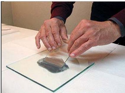
Figura 13 - Smussatura degli spigoli di una lastra di vetro usando polvere abrasiva.
