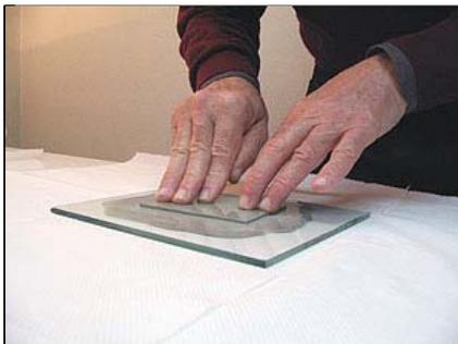
Figura 14 - Smerigliatura di una lastra di vetro usando polvere abrasiva fine.
