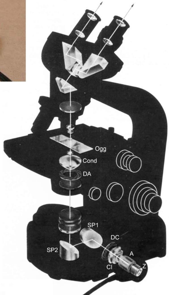
Fig. 29 – Microlampada nella base dello stativo “Gfl” della Zeiss Oberkochen.
