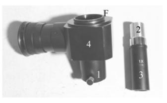
La microcamera possiede un proprio fattore d'ingrandimento che va moltiplicato con quello dell'oculare e dell'obbiettivo principale per ottenere l'ingrandimento finale. Se è previsto un oculare normale, la microcamera possiede in genere una "lente di camera" convergente, che consente di far lavorare l'oculare con seconda coniugata all'infinito, come di norma; se è previsto un proiettivo speciale, la lente di camera può essere inutile.
