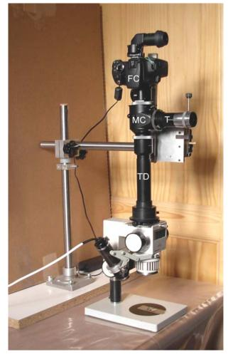
• Inoltre, il semiriflettente della microcamera provoca una perdita fotometrica.
