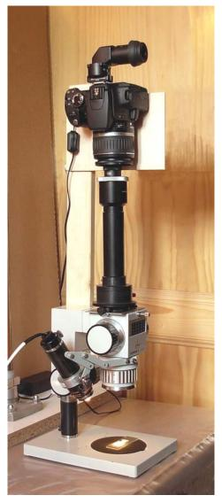
Altrimenti, si può montare la fotocamera su un normale treppiede, ma si ricordi che, ogni volta che si focheggia lo stereo, occorre riposizionare la fotocamera (fig. 5).
