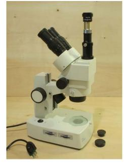
Sono di corredo alcuni raccordi, da avvitare sul filetto F di fig. 2, per alcune fotocamere commerciali private dell'obbiettivo. L'otturatore e l'esposimetro sono quelli della fotocamera.
