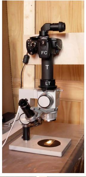
Fig. 7 — Per il fissaggio della fotocamera, conviene avvitare a fondo la vite da 1/4", in modo da sfruttare tutta la profondità del foro presente sulla fotocamera, e poi "risucchiare" la camera con una manopola con foro filettato al centro, sempre a passo 1/4". Una lunga vite da 1/4" ed una manopola in bachelite come quella qui raffigurata sono reperibili in una buona ferramenta. La manopola dovrà portare al centro un foro con diametro non superiore a 5,5 mm, da filettare con i maschi da 1/4".
