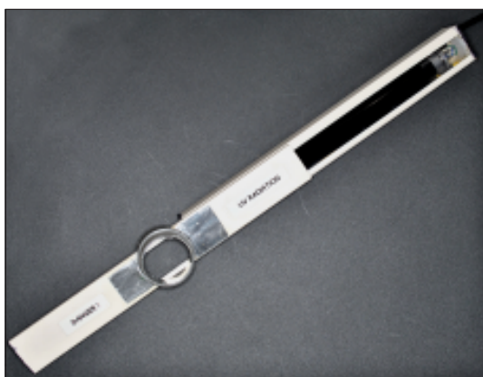
Fig. 24: Il dispositivo illuminatore aperto: si nota il tubo fluorescente dotato di filtro di Wood (nero).
