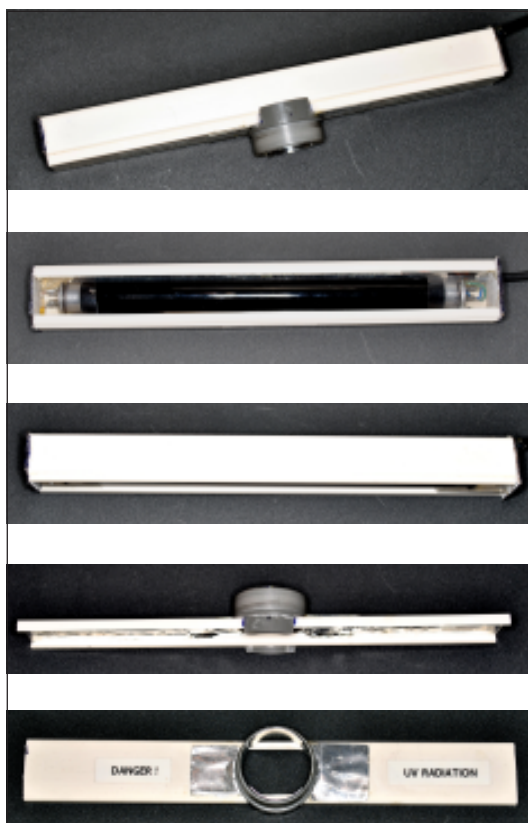
Fig. 25: Varie vedute del dispositivo illuminatore per microscopia in diascopea con eccitazione a UV (Luce di Wood).
