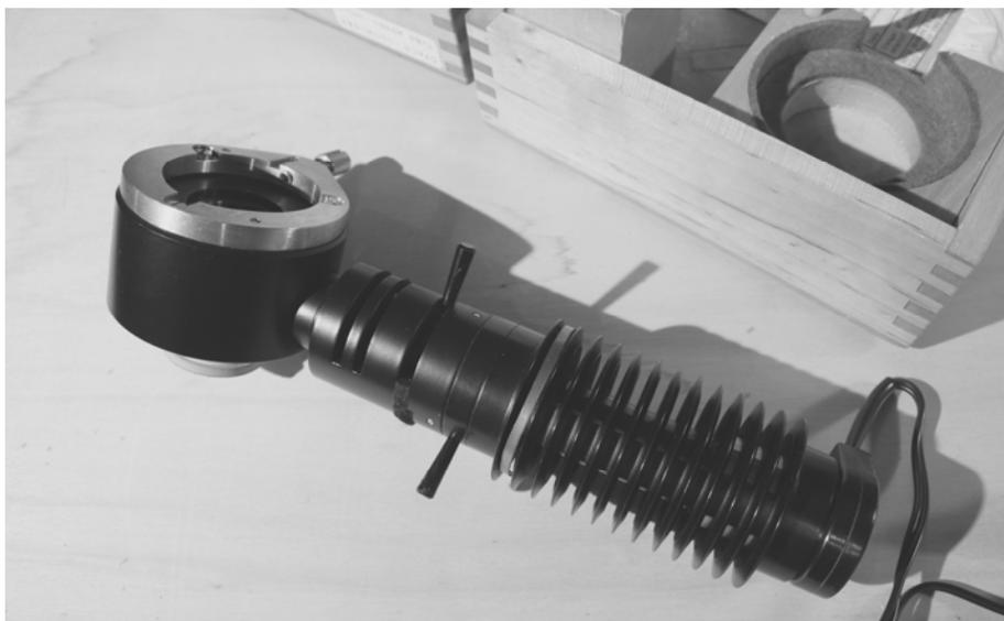
Fig. 5 – Tubo intermedio PZO, con funzioni di illuminatore episcopico. È presente un diaframma di campo (levetta in basso) ed un porta-filtri (levetta in alto), ma non un diaframma d’apertura. L’ampolla è “precentrata” (munita di zoccolo di precisione).
