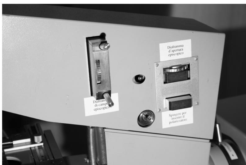
Fig. 4 – Particolare dello strumento precedente, in cui sono indicati i due diaframmi (a destra, quello d'apertura; a sinistra, montato all'interno di un grosso cursore, quello di campo) e la sede per filtri, in basso. A metà strada fra i due diaframmi è visibile una delle due viti di centratura del diaframma d'apertura. Analoghe viti per la centratura del diaframma di campo sporgono obliquamente dal cursore di sinistra.
