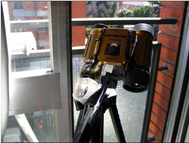
Figura 4 - Binocolo montato su cavalletto e prisma montato su di un oculare per mezzo di nastro adesivo.
