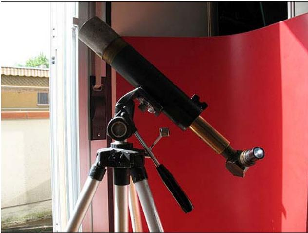
Figura 2 - Cannocchiale puntato verso il Sole. Notate che l'oculare fa un angolo di 90° rispetto al tubo principale.
