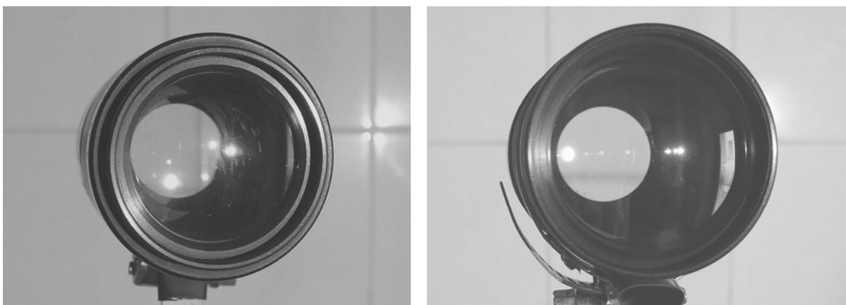
Fig. 5 e 6 – Catadiottriche per riflessione. La lampada si trova alle spalle ed a destra del fotografo, come dimostra il riflesso sulla parete di fondo, presso l'orlo destro della lente.
