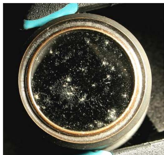
(fig. 15). L'esile strato d'aria che vi s'interpone dà luogo, per fenomeni d'interferenza "da strati sottili" (come avviene nelle bolle di sapone), alla decomposizione della luce bianca in colori di sottrazione. In genere, queste scollature non producono gravi danni.
