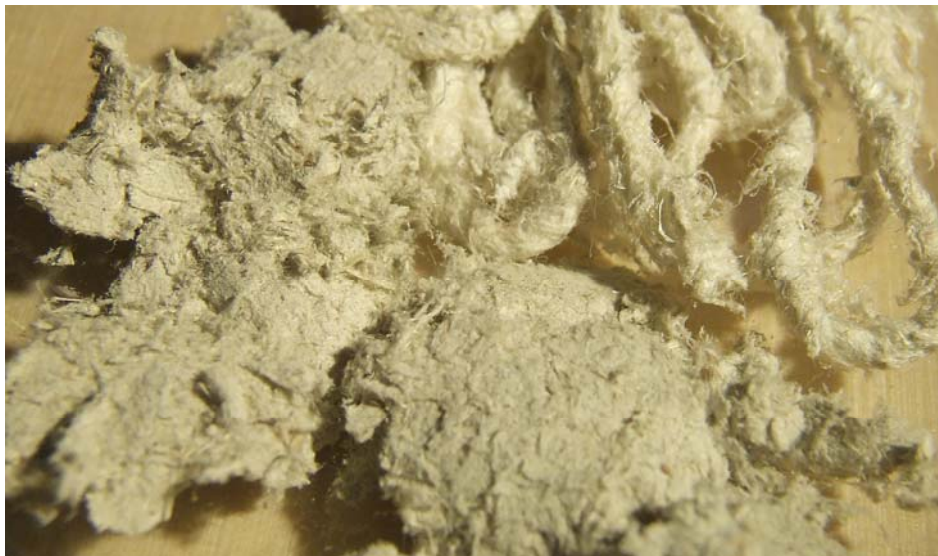
Fig. 4 – Crisotilo allo stato quasi naturale (a sinistra) e tessuto in forma di cordone (a destra). Evidentemente, si tratta di materiale più “morbido” della Crocidolite, in quanto le fibre sono più sottili e flessibili. M = 2,5 : 1 .
