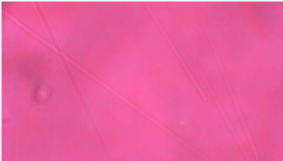
Fig. 13 – Fibre di vetro. Notare l'andamento dritto a diametro costante, lo scarso rilievo (indice simile a quello della resina di montaggio) e l'assenza di colori d'interferenza, dovuto alla mancanza di birifrazione. Le fibre di vetro si possono confondere solo con la lana di roccia.
