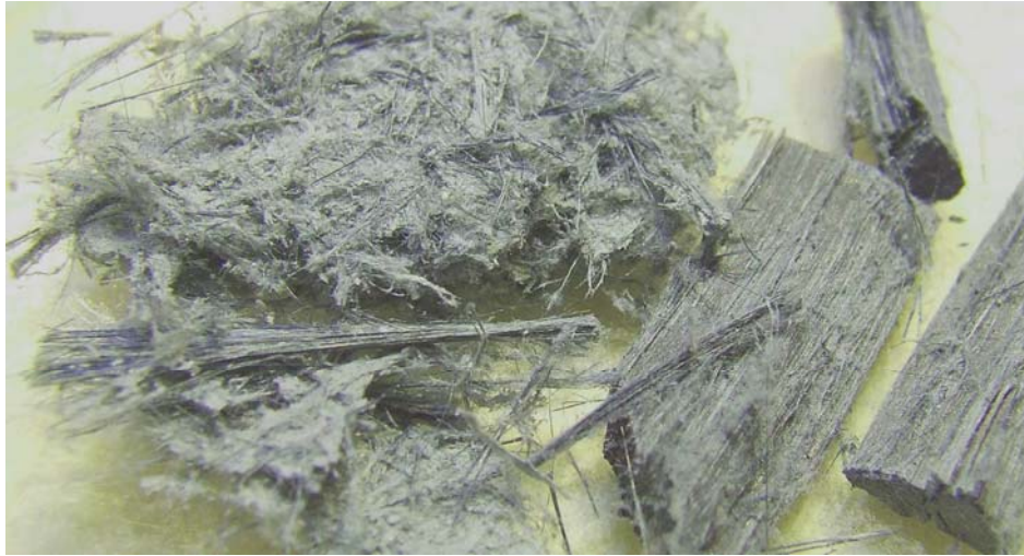
Fig. 3 – Crocidolite dalla miniera di Pomfret (Sud Africa). Diversi campioni in diverso stato di disaggregazione. M = 2,5 : 1 (supponendo che la figura venga stampata rispettando il formato A4).
