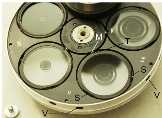
Il caso descritto è assai frequente negli strumenti di certi costruttori: bastano pochi mesi di disuso e tutto si blocca. Metà del tempo del riparatore viene assorbito dalla sostituzione dei grassi induriti.
