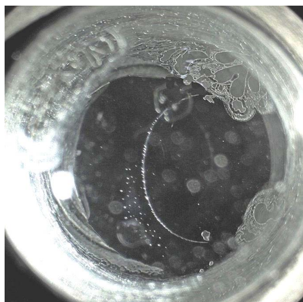
Fig. 13 (sotto) – Obiettivo Lomo Plan Apocromatico 40/0,65. Scheda tecnica n° 63. L'obiettivo è composto da tre doppietti ed un tripletto – più la frontale – e contiene quindi cinque superfici incollate.
