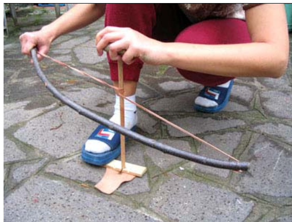
Figura 5 - Muovete avanti e indietro l'archetto in modo da fare ruotare l'asta.
