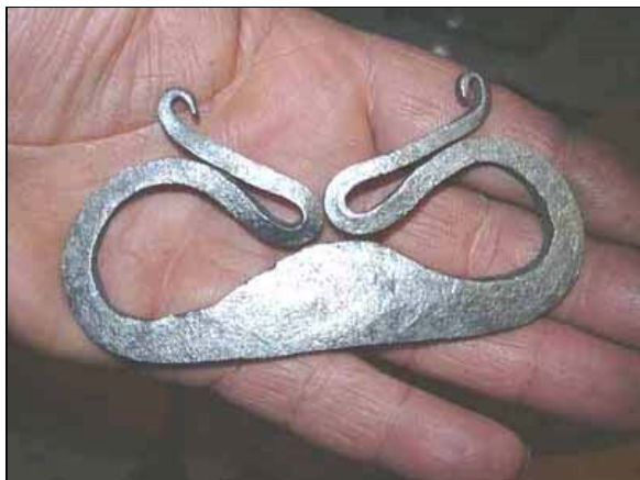
Figura 14 - Un acciarino. La sua forma è tale da poter essere impugnato ed usato senza sbucciarsi le dita.
