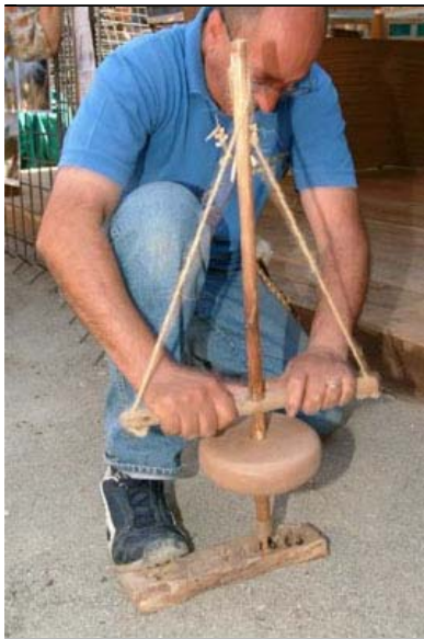
Figura 9 - Rotazione di una bacchetta su di una tavoletta per mezzo di un trapano a volano.
