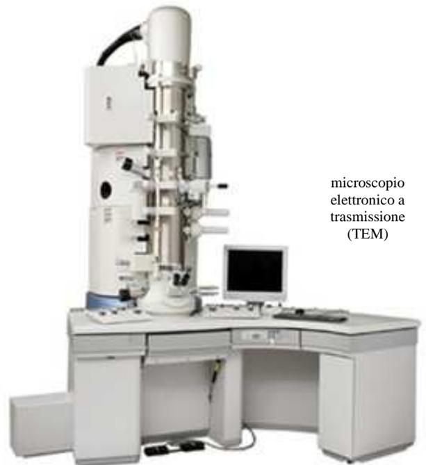
microscopio elettronico a trasmissione (TEM)
