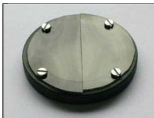
Figura 5 - Filtri polarizzatori e loro montatura.
