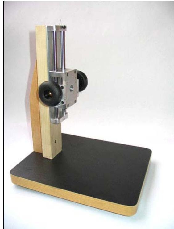
Figura 15 - Carrello e sistema di manovra montati.
