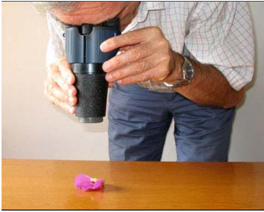
Figura 2 - Ponendo un binocolo compatto sopra una lente acromatica abbastanza grande, è possibile vedere ingranditi e nitidi gli oggetti posti alla distanza focale della lente. Quello che manca è lo stativo. In questo articolo, ci occupiamo della sua costruzione.
