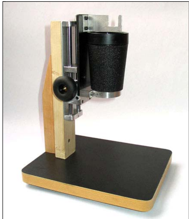
Figura 19 - Microscopio completo dell'obiettivo comune. Notate in alto la staffa per il fissaggio del binocolo compatto.
