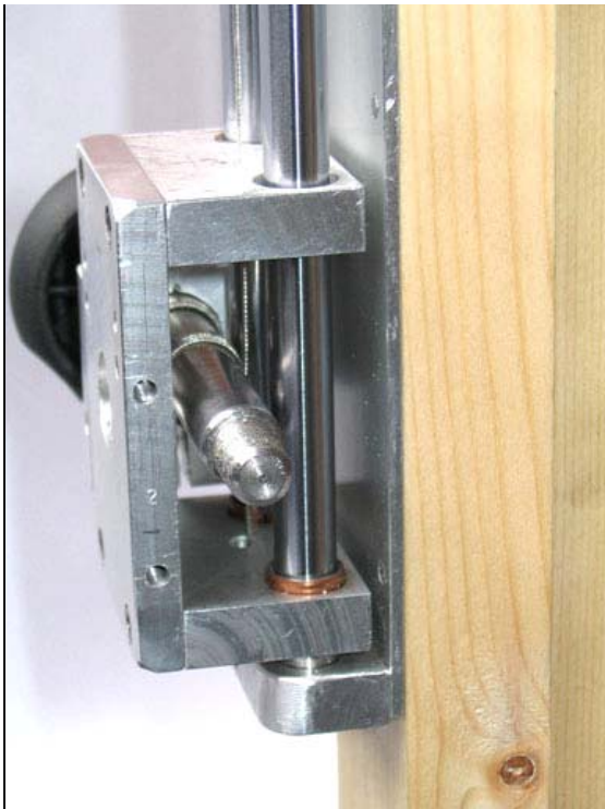
Figura 14 - Per montare più agevolmente il cavo, togliete provvisoriamente uno dei supporti della barra di manovra.
