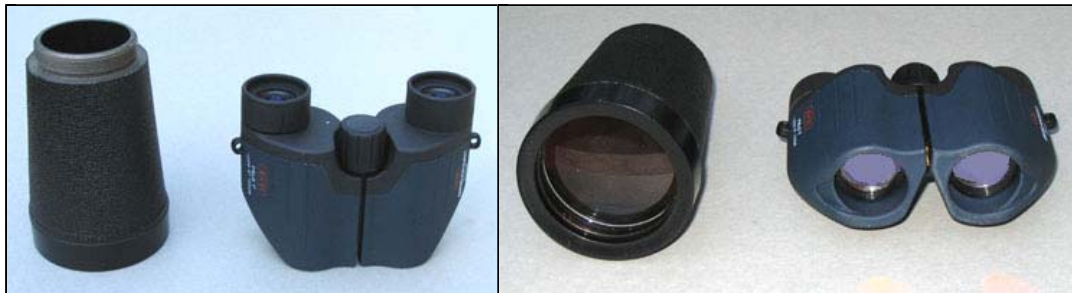
Figura 4 - A sinistra: obiettivo di binocolo, a destra: binocolo compatto. Nota come gli obiettivi del binocolo compatto sono abbastanza vicini da potere guardare all'interno della lente di sinistra.
