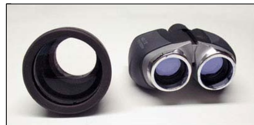
Figura 8 - A sinistra: obiettivo di binocolo, a destra: binocolo compatto. Gli obiettivi del binocolo compatto sono abbastanza vicini da potere guardare all'interno della lente di sinistra.
