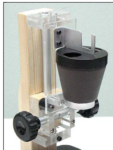
Figura 19 - Obiettivo comune montato sul carrello.
