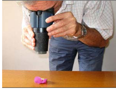
Figura 4 - Passo 2: ponendo un binocolo compatto sopra l'obiettivo di un binocolo, si ottiene un microscopio stereoscopico.
