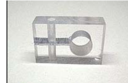
Figura 11 - Supporto con intaglio di sega per renderlo elastico.
