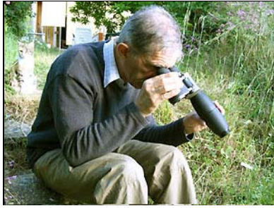
Figura 3 - Passo 1: svitando un obiettivo di un binocolo e ponendolo davanti all'altro si ottiene un microscopio.
