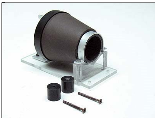
Figura 18 - Supporto dell'obiettivo comune. Sotto: distanziali e viti per il montaggio sul carrello.
