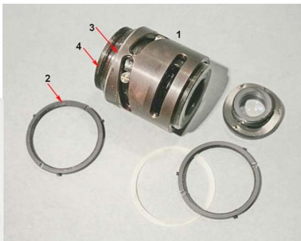
Fig. 3008 (a sinistra) – Ecco l'anello 2 che fissava il sistema zoom alla piastra di base, con tre grani di sicurezza (5).
