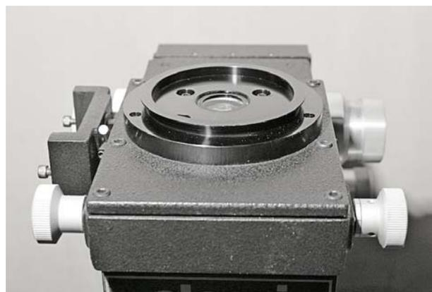
Fig. 2990 (a sinistra) – La piastra superiore del blocco 10, con un prisma (2° schema di Porro) per il raddrizzamento dell'immagine finale. Dato l'uso particolare, questo strumento non dà l'immagine rovesciata, come di consueto. Nella scheda precedente abbiamo visto un diverso prisma per il raddrizzamento ("a tetto").
