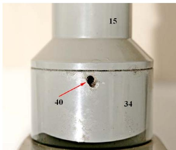
Fig. 3069 – Il tubo 34 si prolunga, all'interno del blocco 2, in un tubo brunito recante una lente. Tale lente si svita e si può pulire senza difficoltà.
