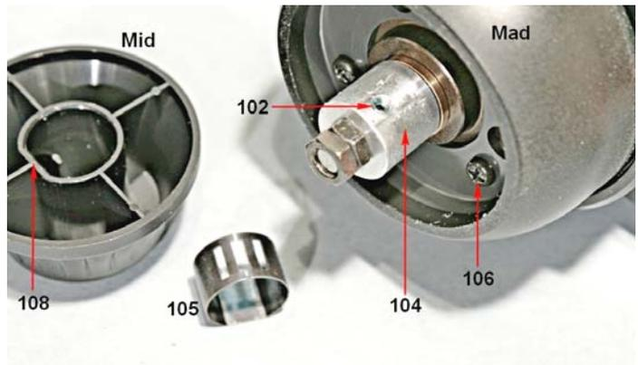
Fig. 3041 – Allentato il grano 102, si possono svitare i dadi 103 dall'estremità dell'albero micro (110 – si vede la relativa filettatura) e si può sfilare il cilindretto 104. Sotto quest'ultimo, fare attenzione alle due rondelle 111 (una piana ed una elastica e flessibile) ed all'anello d'ottone 112.
