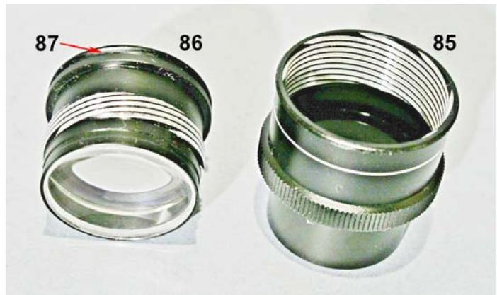
Fig. 3034 – Nel tubo 86, sopra al menisco inferiore sopra citato, si trova un doppietto (88). Presso l'orlo superiore del tubo 86 si trova un filetto in cui s'avvita il barilotto 89; in questo è incastonata la lente oculare (emergente) dell'oculare.
