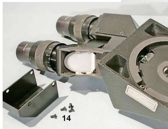
Fig. 2979 (a sinistra) – Sotto l'altro coperchietto, appare il secondo specchio laterale.
