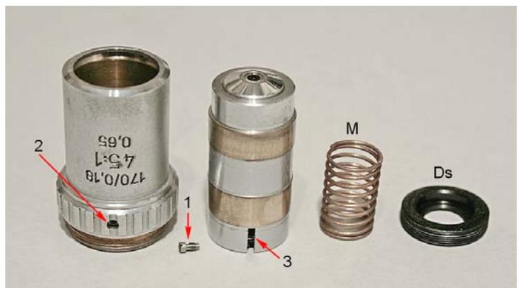
L'inconveniente del nostro meccanismo è che, se non si toglie la vite 1, il barilotto generale non si può estrarre. Inoltre, quando si rimonta l'obiettivo, prima di introdurre la vite 1, occorre essere sicuri che la fenditura 3 si trovi proprio sotto il foro. Occorre procedere per tentativi. Quest'obiettivo non mostra fori di centratura: tutto è affidato alle tolleranze di lavorazione.
