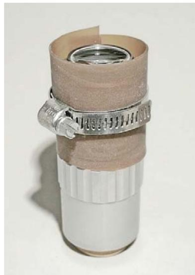
Nella scheda tecnica n° 72 si è descritto il caso di un obiettivo Zeiss Jena GF Planapo 100 nelle stesse condizioni: errore di centratura ed impossibilità di smontarlo a causa del cemento con cui il costruttore ha bloccato fra loro varie parti. Rimandiamo a quel testo per i dettagli.
