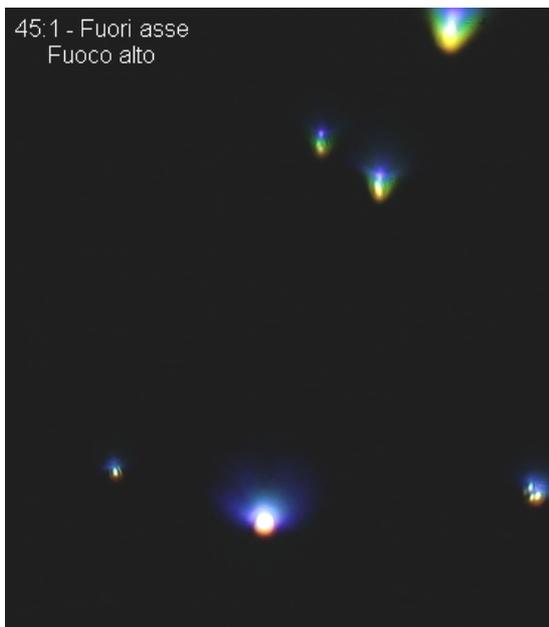
Fig. 3098 a/b/c – Nulla da stupirsi se, ai margini di un campo di 18 mm, si manifesta una buona dose di coma simmetrica. Rientra nelle caratteristiche di un classico acromatico.
