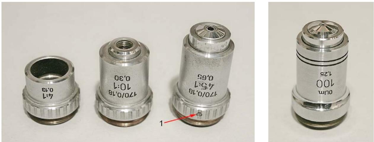
Fig. 3087 – Nel 45:1 si noti la vite 1, di cui vedremo la funzione. Il termine ad immersione, 100:1, sembra di una serie anteriore, ed è contraddistinto da due anelli neri – per indicare l'immersione, di solito, se ne usa solo uno. Il 45:1 ed il 100:1 sono a montatura molleggiata.
