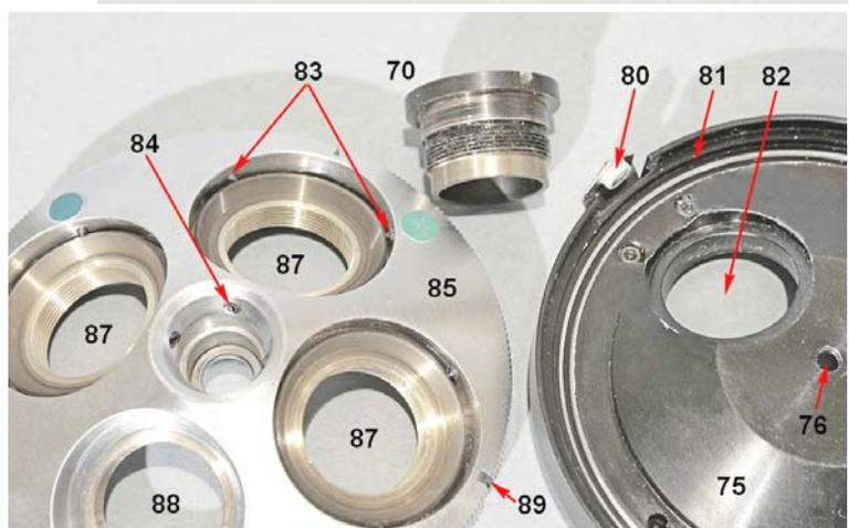
Fig. 3002 – Sull’orlo del disco girevole, per ogni foro centrabile vi sono due grani (83), sei grani per i tre dischi centrabili (87). Per il terzo grano, vedi qui sotto.
