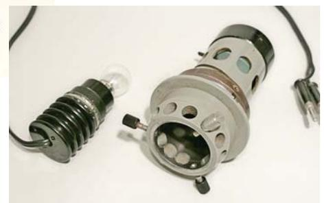
Fig. 3083 – Ecco il barilotto 103 del collettore (che funziona anche da condensatore) in cui si vede un primo anello a due tagli (106) che fissa un filtro e la lente superiore del collettore.
