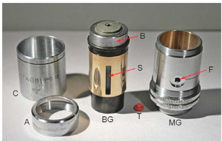
Fig. 3112 – Il filetto F3 serve al fissaggio dell’anello B. Sotto di questo, si vede il barilotto della lente frontale (Fr).
