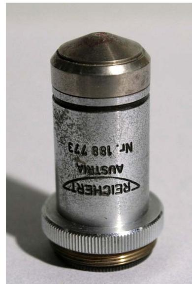
Fig. 3116 – Già ad occhio nudo, appare che la lente frontale è fortemente obliqua. Un'eccessiva pressione in sede di pulitura od un urto possono spiegare questo spostamento, ma vedremo che qualche dettaglio meccanico del barilotto ha facilitato l'incidente.
