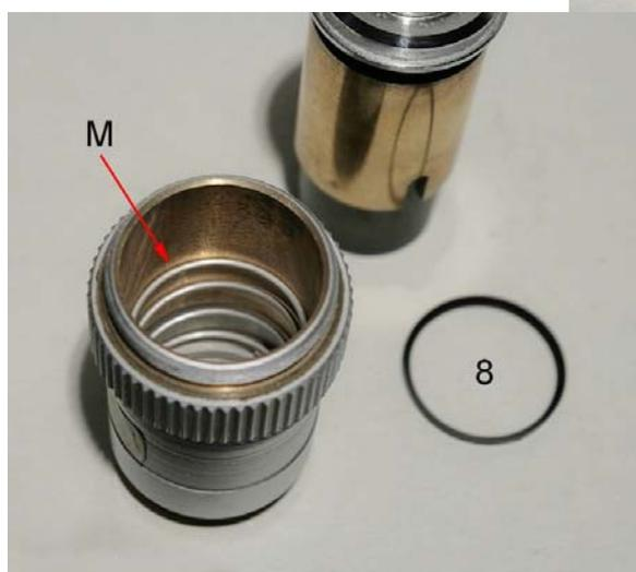
Fig. 3143 (sinistra) – Smontando il barilotto generale, appare internamente alla montatura generale la molla (M) che spinge il barilotto verso il basso. Fra molla e barilotto generale si trova un anello di plastica (8), a sezione triangolare: la faccia piana va rivolta verso la molla.
