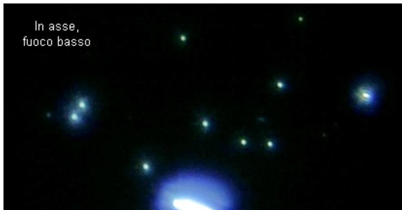
Fig. 3135 – Ai margini di un campo di 18 mm, e con un oculare semi-compensatore, si vede solo un leggero allungamento delle centriche, essenzialmente dovuto ad un residuo (molto piccolo) di cromatica laterale.
