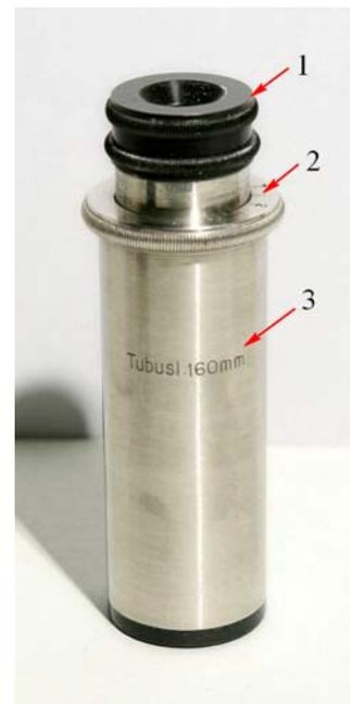
L'oculare è un acromatico negativo con un diaframma di campo visivo di 8 mm ed un pupilla d'uscita a livello della lente superiore. La focale (misurata) è di circa 60 mm. L'ingrandimento visuale equivalente sarebbe circa 4 ×,
