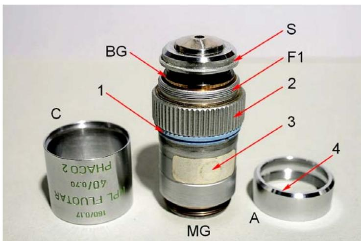
Fig. 3142 (a destra) – Come abbiamo detto, dopo aver svitato l'anello a vite A dal filetto F1, il barilotto generale si sfilava verso il basso. Prima occorre staccare l'etichetta adesiva 3 che tiene in posizione il chiodo plastico 5; questo, attraverso il foro 6, entra nel piccolo canale 7 ricavato dal barilotto generale, con lo scopo di impedirne la rotazione sul relativo asse.
