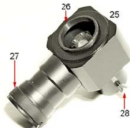
Fig. 3171 – Un caso pratico di “microcamera” classica. Nel corpo (25) si trova una superficie semi-riflettente (in genere un prisma con superficie interna diagonale) che divide il fascio formatore d'immagine, proveniente dall'obbiettivo, in una parte diretta al “mirino” (27) ed una diretta alla “lente di camera”, posta subito sopra il prisma. Con la vite 28, la microcamera si fissa al tubo del microscopio, in modo che essa appoggi sull'oculare.
