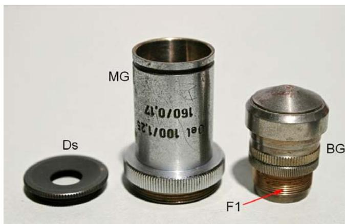
Fig. 3119 – Da quello che abbiamo chiamato “barilotto generale” (BG) si svita il barilotto frontale Fr ed il filetto corrispondente è F2.
