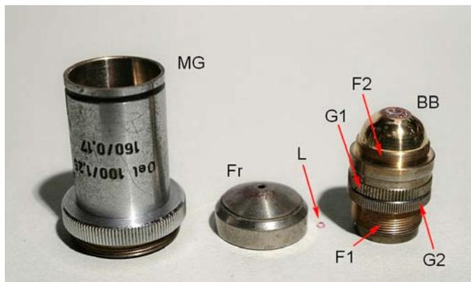
Fig. 3120 – Il blocco BB si dimostra formato da un barilotto B1 (portatore del menisco che sta sopra alla frontale e terminato dalla corona godronata G1) e da un gruppo sovrastante (F1 – B2) che porta la corona godronata G2 ed il filetto F3 (destinato al fissaggio del barilotto B1).
