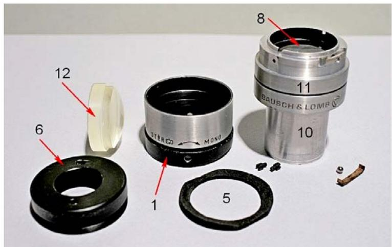
Fig. 3164 (a destra) – Ultima notazione: in basso alla parte 10 sporge una piccola spina (14). Essa serve ad obbligare i due oculari a stare nella posizione corretta; se si invertisse il destro col sinistro i due assi ottici risulterebbero divergenti invece che convergenti. Purtroppo, tale spina impedisce di utilizzare questi oculari in uno stativo normale, nei cui tubi porta-oculari manchi una fessura capace di accogliere quella spina.
