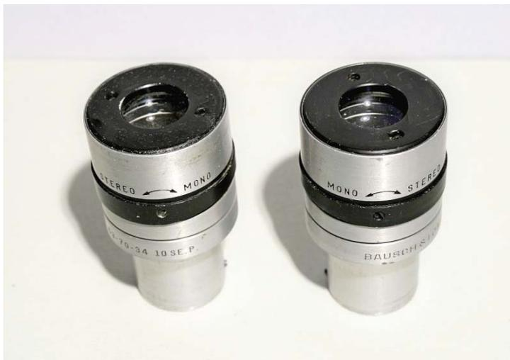
Fig. 3159 – Le scritte sui due oculari sono invertite, come ad indicare due rotazioni in senso opposto della parte superiore dei due sistemi. Infatti, l'anello nero intermedio dell'oculare (vedi 1 nella figura seguente) ha forma cuneiforme (2, nella stessa figura) e l'anello 1 è imperniato da due vitine diametralmente disposte (3) che gli consentono di basculare.
