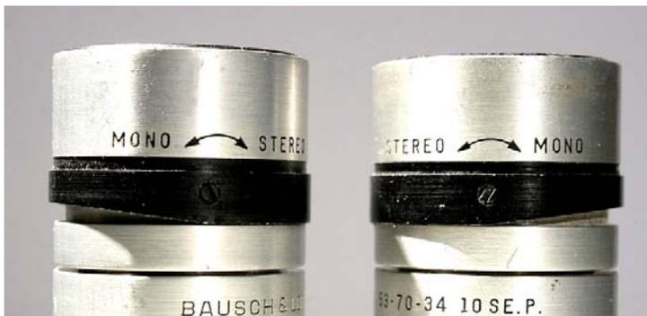
Fig. 3160 – Infatti, con piccolo sforzo, la parte superiore del sistema si può inclinare di circa 7°. Se gli oculari sono disposti come in figura, gli assi ottici fra le loro parti superiori risultano convergenti fra loro di circa 14°.
