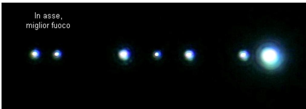
Fig. 3152 – Le centriche sopra e sotto il miglior fuoco sono molto simili fra loro: anche la sferica è accettabilmente corretta.
