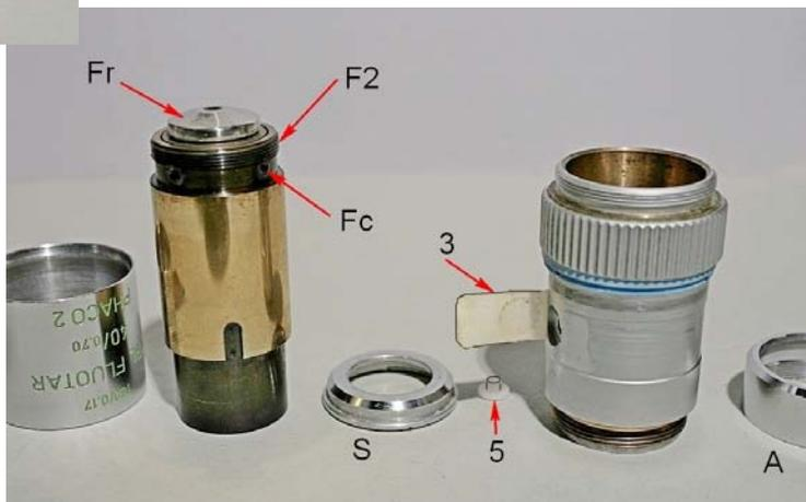
Fig. 3145 – Purtroppo, il costruttore ha riempito i fori di centratura con un materiale gommoso, nella lodevole intenzione di bloccare la lente flottante al termine della centratura. Usando un cacciavite da 1,2 mm come fresino, i fori sono stati liberati.
