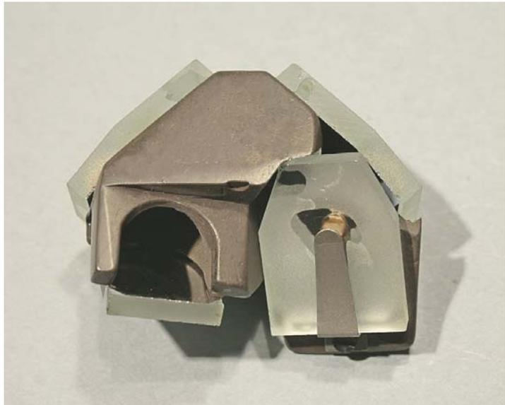
Fig. 1847 – Nel porta-specchi sinistro, visto di lato, appaiono i due specchi intermedi. Uno di questi specchi si era spostato, spiegando la perdita di parcentatura: la vite V4 era lenta e l'adesivo aveva ceduto.
