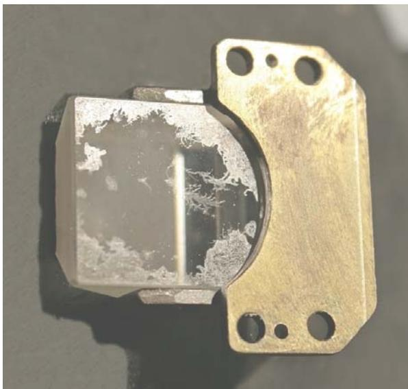
Fig. 1863 (a destra) – La superficie riflettente del prisma inclinante, benché ricoperta da una vernice protettiva, mostra anch'essa due grosse macchie di alterazione, rese visibili dalle riflessioni sulla superficie inferiore.
