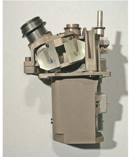
Fig. 1844 (sopra) – Più da vicino, si vede il telaio principale (Tp) sul quale è fissato da tre viti (come V3) l'arco Ar. Sull'arco Ar si avvitano le due grosse viti Vp che fungono da perno per il movimento dei due porta-oculare PO. Sopra ognuno dei porta-oculare è fissato (e cementato) il tubo porta-oculare (Bi); sotto, il gruppo specchi (PS), fissato da tre viti. Su PS sono fissati i quattro specchi (come Sp), ognuno con una molletta a squadra (vite V4) e qualche goccia di adesivo ai bordi.
