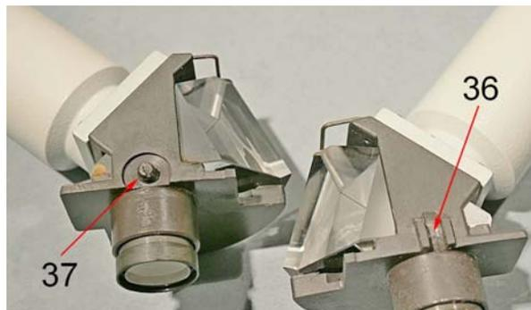
Fig. 1922 (a destra) – Sul fianco della gabbia un paio di fori sono ripieni di adesivo che penetra nell'intercapedine fra prisma e gabbia e blocca la posizione del prisma stesso.
