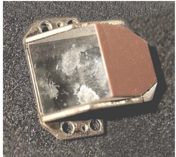
Fig. 1864 (a sinistra) – Anche la superficie interna della lente di tubo è diventata una giungla per le muffe.
