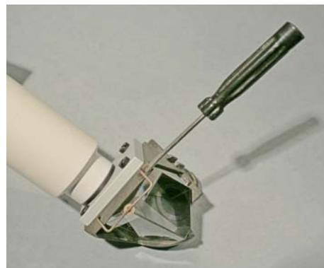
Fig. 1923 (a sinistra) – Con un cacciavite, è facile estrarre la molletta 30 dai due fori presenti sull'orlo della gabbia: basta inclinare la lama del cacciavite e far leva costringendo le due punte della molletta ad uscire dal foro.
