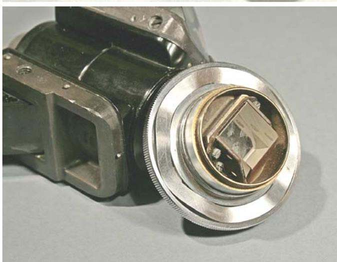
Fig. 1851 – Questo tubo presenta una funzione piuttosto insolita: una manopola apicale (9) che serve a regolare la frizione nel movimento reciproco fra i due semi-tubi. Basta un mezzo giro per bloccare o sbloccare il movimento.
