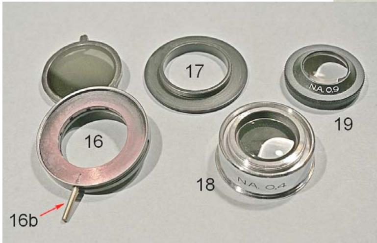
Fig. 1876 (a sinistra) – Il diaframma d'apertura (16) si avvita da sotto sull'anello 17. Il diaframma porta inferiormente un porta-filtri estraibile in cui è incastonato un filtro grigio neutro.
