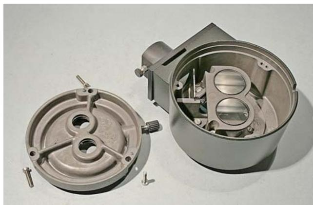
Fig. 1934 (a destra) – Sotto la piastra superiore e sotto i polaroid, un pezzo triangolare fissato da altre tre viti porta cinque lamine plan-parallele ed una lente divergente, l'ultima lente del sistema illuminante.
