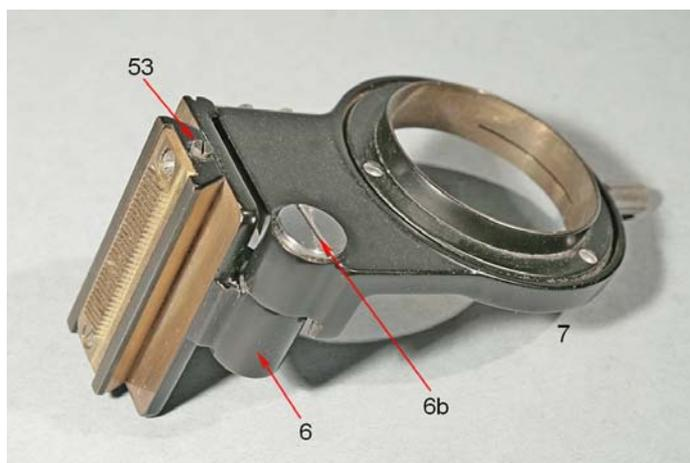
Fig. 2110 – Per confronto con la fig. 2095 (pag. 849) si vede che, tolta la scatola portalamпада (PL), è possibile sfilare da sotto la squadra porta-condensatore dalla guida PC presente nel porta-tavolino.
