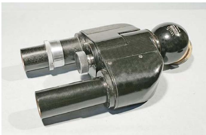
Fig. 2152 – Delle cinque viti che fissano ogni coperchio, una è più corta (quella inferiore).
