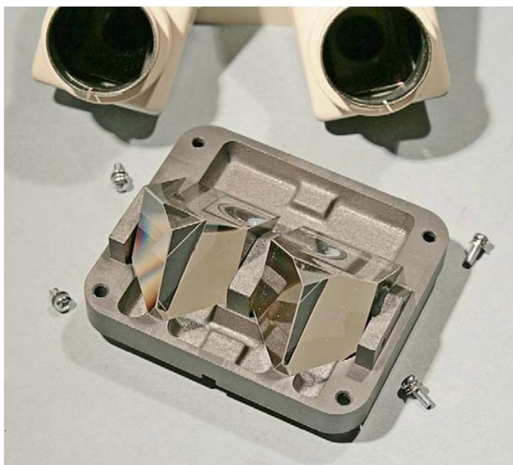
Si dovrà operare con tutto lo strumento montato e funzionante; le viti sono accessibili se si riescono a togliere i quattro chiodini in plastica 5 (fig. 1954) e l'anello 12 e si solleva il coperchio 10. Orientando opportunamente la scatola porta-prisma, le tre viti (30, nella figura seguente) divengono accessibili attraverso i fori 15 (fig. 1957).
