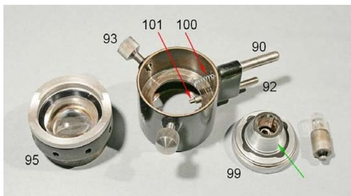
Fig. 2131 – Il collettore è formato da un anello inferiore (95) su cui si avvita un anello (94) che mostra la sede per filtri ed il sistema ottico.
