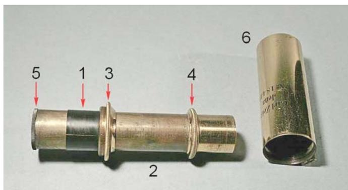
Fig. 2018 – Svitando l'anello scuro (5) dall'estremo inferiore del tubo interno (2) si può sfilare quest'ultimo dalla fascia 1.
