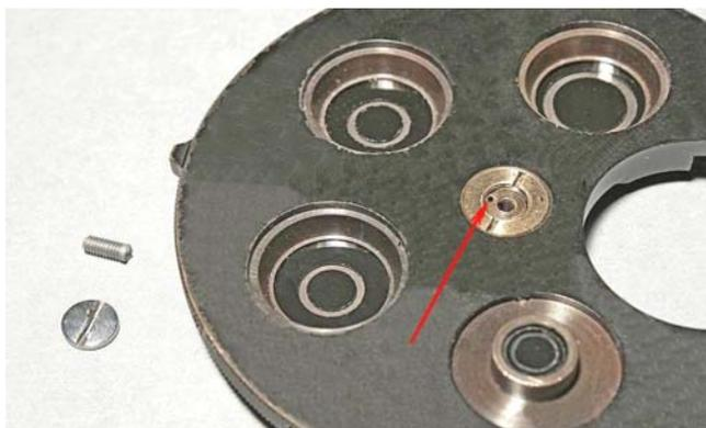
Fig. 2115 (a sinistra) – Di lato, la vite rotta a filetto sinistro ed il colpo di bulino sul perno 66b. Il disco rotante 67 è qui isolato.
