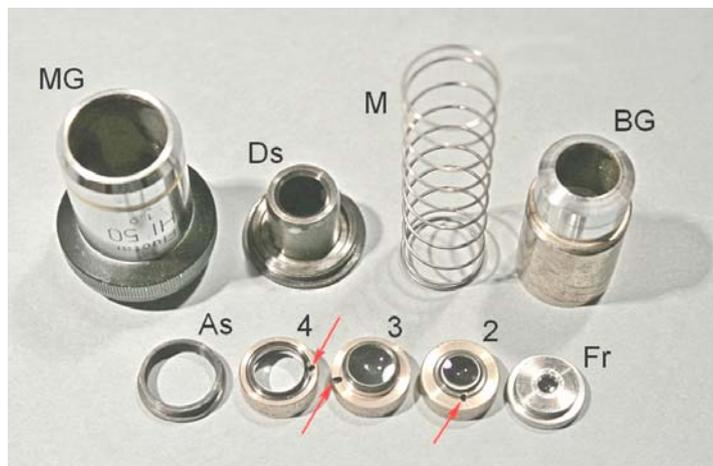
La pila dei barilotti singoli scorre nel barilotto generale con minima tolleranza; se ne deduce che il costruttore ha tenuto nella centratura delle singole lenti una precisione tale da rendere inutile la correzione dei residui di coma in asse, quindi la centratura finale di una lente flottante. Questi obbiettivi sono infatti di costruzione attorno al 1950, quando le tolleranze di lavorazione erano tenute molto strette.
