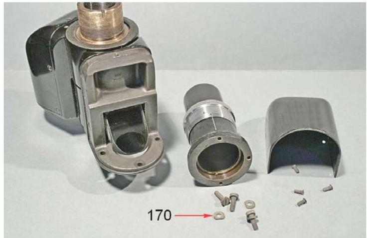
Fig. 2154 a/b – La boccola destra non è regolabile ed è fissata dall'interno ancora da tre viti che però fissano anche la flangia di un barilotto (171) che porta un cilindro in vetro: una "lamina plan-parallela" destinata a garantire l'identità dei cammini ottici dei due canali del tubo. In base ai soli prismi separatore e deviatori, infatti, il cammino ottico dei due canali di un tubo sec. Siedentopf non sarebbero uguali.
