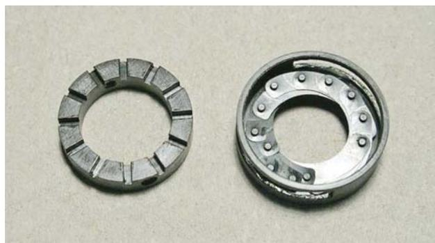
Fig. 2169 – Terminato il montaggio, si consiglia di avvitarne immediatamente i perni 16 o 17 in modo da impedire che i due anelli del diaframma si separino. In questo modo è possibile immergere e sciacquare a lungo il diaframma nel solvente senza rischiare di disfare il lavoro già fatto.
