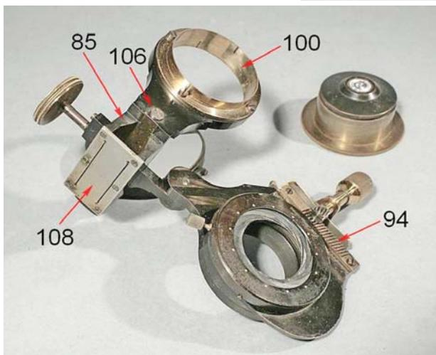
Fig. 2056 (a sinistra) – Da dietro, si vede meglio l'anello spaccato 100, la vite 106 che costituisce il fincorsa superiore del condensatore e la guida trapezoidale interna del pezzo basale 85. In questa guida scorre la guida maschio con cremagliera (79), già vista nelle figg. 2047/48/49/52 (pagine precedenti). Per eliminare il gioco fra la guida maschio 79 e la guida interna del pezzo 85 è prevista la pressione elastica della piastra 108, opportunamente provvista di due tagli longitudinali.
