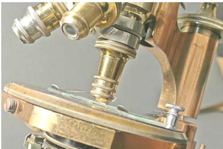
Per ottenere la massima risoluzione possibile, vicina al limite teorico indicato dalle leggi della diffrazione (circa 0,24 millesimi di mm), occorre inserire l’obbiettivo più forte, marcato “1/12”. Si tratta di un obbiettivo “ad immersione” che funziona correttamente solo interponendo fra la lente frontale dell’obbiettivo ed il vetrino una goccia di olio speciale con lo stesso indice di rifrazione e la stessa dispersione del vetro (“olio per immersione”).<sup>5</sup>
