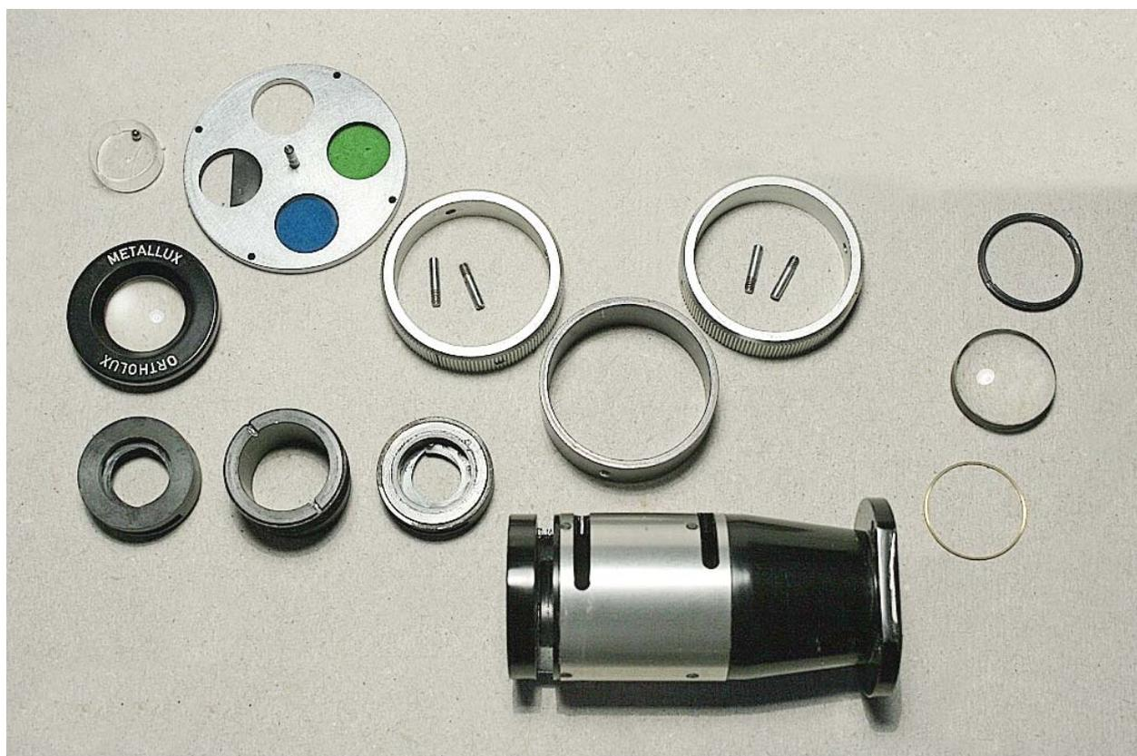
Fig. 2167 – Non sarà difficile riconoscere qui le varie parti dell'illuminatore, come esaminate separatamente nelle foto precedenti.
