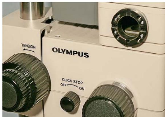
Fig. 1952 – Il lato sinistro dello strumento. In alto a destra, l'attacco per un raccordo per fotocamera
