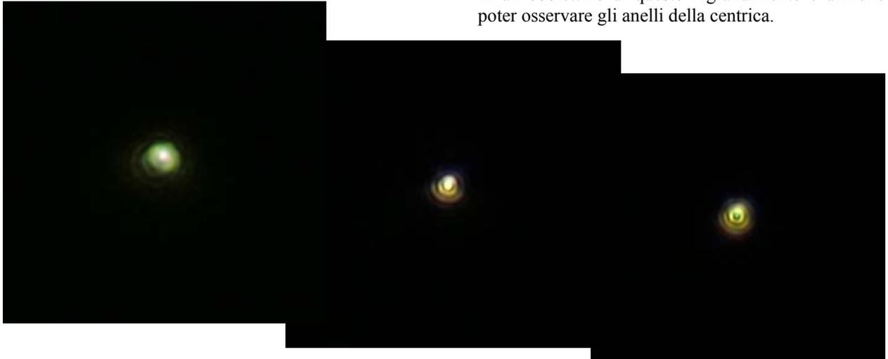
Fig. 2089/90/91 (sotto) – Ai bordi di un campo di 18 mm, la centrica è leggermente alterata, ma soprattutto si vedono i segni della cromatica laterale.
