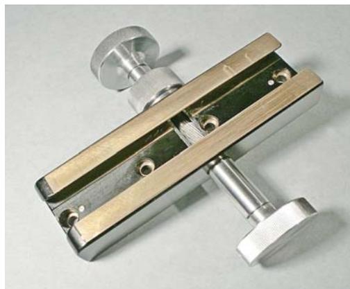
Fig. 2136 (a destra) – Per togliere le due manopole MA occorre sfilare le spine coniche 130 dai fori 130b e 130c; inutile dire che, in sede di rimontaggio, tutti quei fori devono corrispondersi e, essendo conici, nel verso giusto. Non perdere di vista le rondelle in plastica 131 che servono a ridurre il gioco trasversale dell'albero 132.
