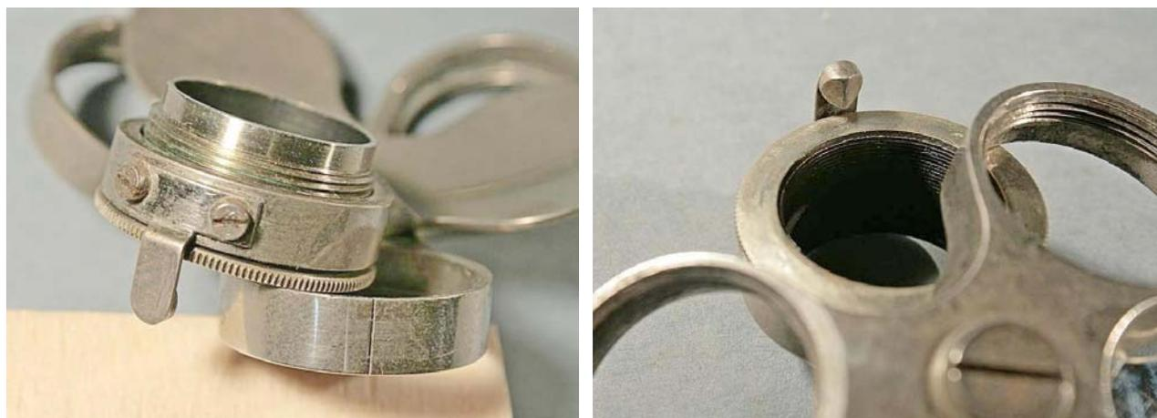
Figg. 2029/30 – Qualche ulteriore dettaglio del revolver, facilmente interpretabile. A destra, è ben visibile la punta del piastrino 34 (il pezzo è rovesciato).
