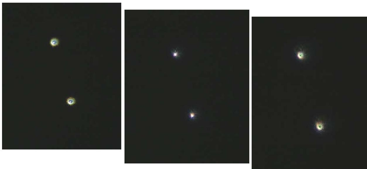
Fig. 2081/82/83 (sotto) – Ai margini di un campo di 18 mm, al di sopra, in corrispondenza, e sotto il miglior fuoco. La centrica non è certo perfetta, ma un obiettivo acromatico non può dare di più. Del resto, non si notano gravi residui di aberrazioni extra-assiali.
