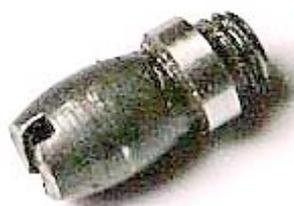
Fig. 3339 (sopra) – Il grano 7 ha la testa a barile, che s'inserisce nel foro (non filettato) del tubo 6. Il gambo cilindrico scorre nella fessura 9 ed il filetto si avvita nel foro 32 (filettato) del tubo 33 della figura seguente.
