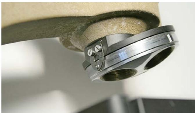
Il condensatore (vedi oltre)(42) è scorrevole all'interno di una guida cilindrica dotata di una fessura elicoidale (44). La barretta 43, fissata al condensatore stesso, ne provoca la rotazione e quindi il movimento verticale, la focalizzazione, poiché scorre nella fessura 44.
