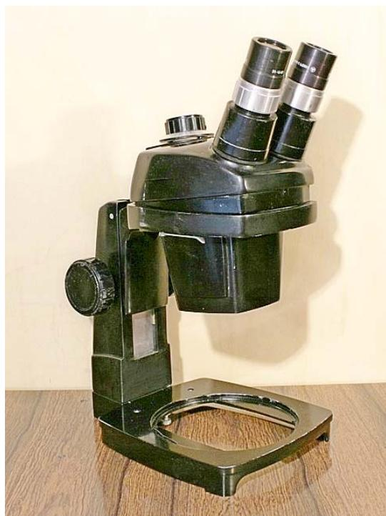
Fig. 3294 (a sinistra) – Questo è lo strumento. Un sistema stereoscopico a schema Greenhough con variatore d'ingrandimento a zoom (comandato dalla manopola superiore).
