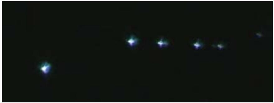
Fig. 3371 – Con fuoco basso, appaiono le altre focaline astigmatiche, radiali.
