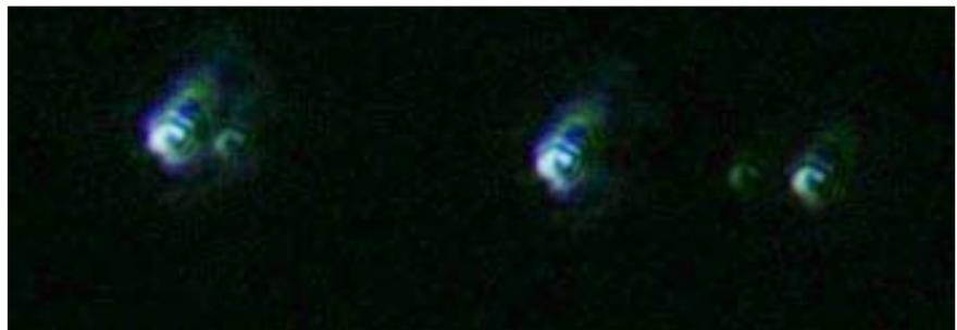
Fig. 3369 – Ai bordi del campo di un oculare compensatore Periplan  $10\times/18$ , ancora con tre foto sopra, nel miglior fuoco e sotto di esso, sono evidenti i segni di un residuo di astigmatismo poco simmetrico. Focaline tangenziali.
