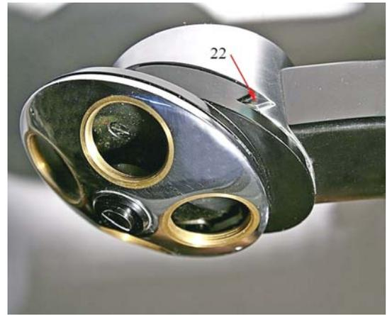
Fig. 3384 (a sinistra) – La lamina 22 è evidentemente curva. Essa è fissata ad un fianco della coda maschio dalla vitolina 23.
