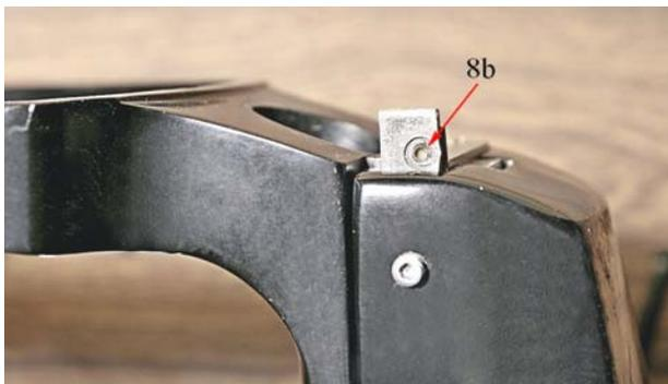
Fig. 3307 (a sinistra) – Il rivetto 8b sulla faccia esterna del lardone 9d.
